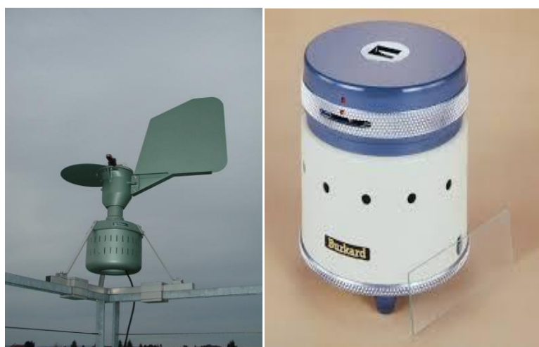
Εικόνα 1.14. Ογκομετρική παγίδα γύρεως τύπου Hirst (Πηγή MeteoSwiss).
