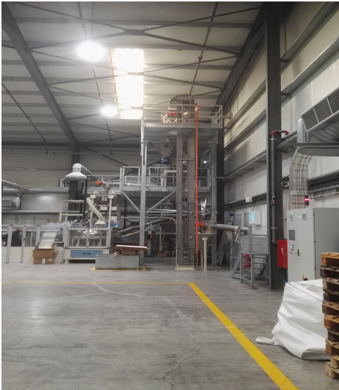
Εικόνα 2: Γραμμή συσκευασίας λευκής ζάχαρης 1 kg
