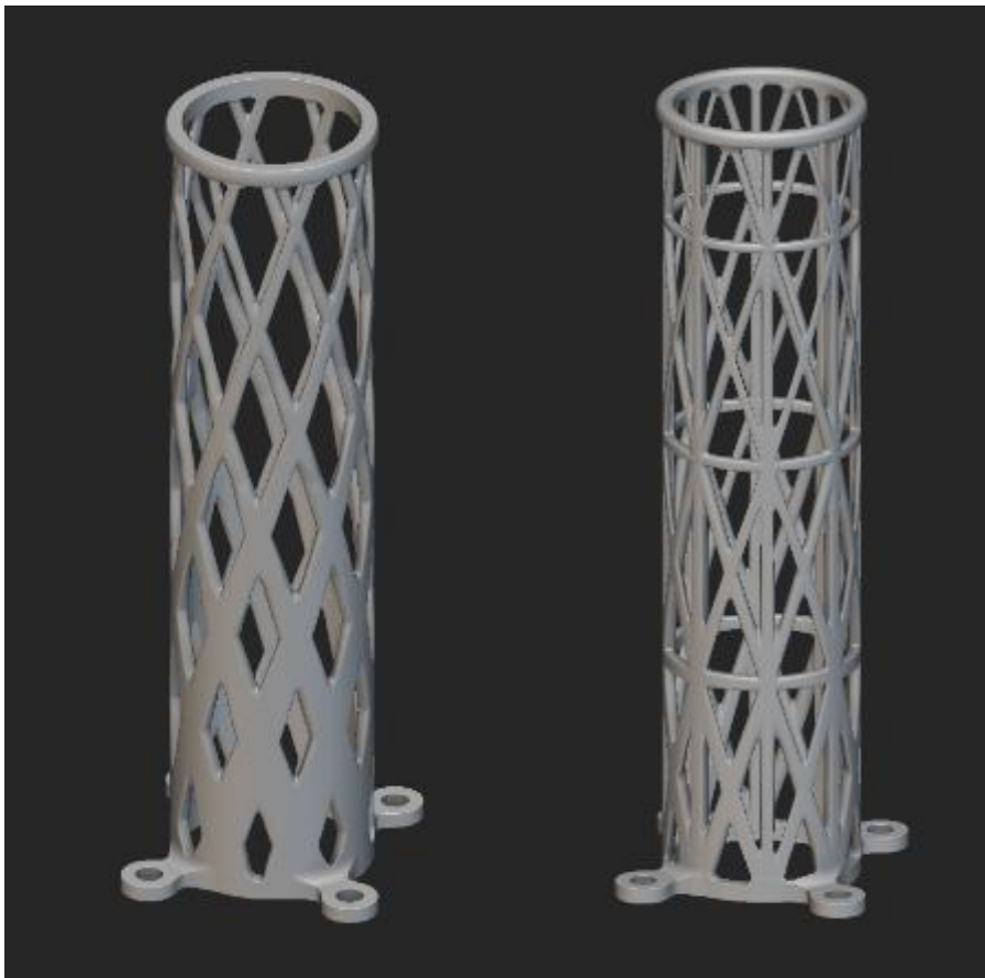
Εικόνα 3-25. Επανασχεδιασμένο bracket. Αριστερά: Diamond lattice. Δεξιά: Octet lattice
