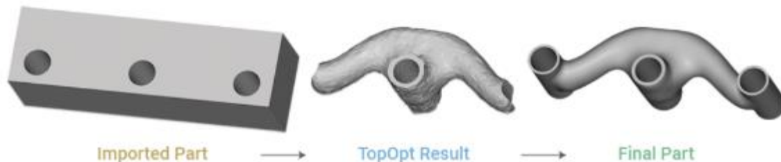
Εικόνα 2-36. Παράδειγμα σταδίων τοπολογικής βελτιστοποίησης
