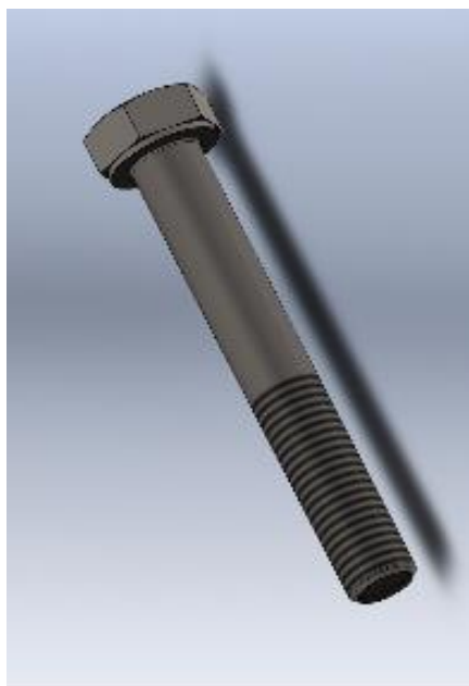
Σχήμα 3-2. Κοχλίας ISO 4014. Αριστερά: 3D περιβάλλον SolidWorks. Δεξιά: Διάστασεις από τις βιβλιοθήκες του SolidWorks
