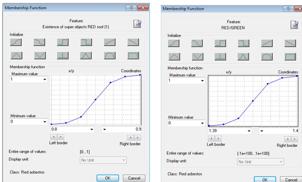
Εικόνα 3.52 (α) Συνάρτηση συμμετοχής και όρια ασάφειας για τον δείκτη “Existence of super objects “RED roof” (β) Συνάρτηση συμμετοχής και όρια ασάφειας για τον δείκτη “RED/GREEN”.
