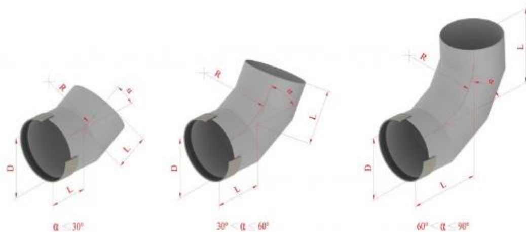
Σχήμα 1.8: Ανάλυση Διαστάσεων Γωνιών από Σύνθετα Υλικά
