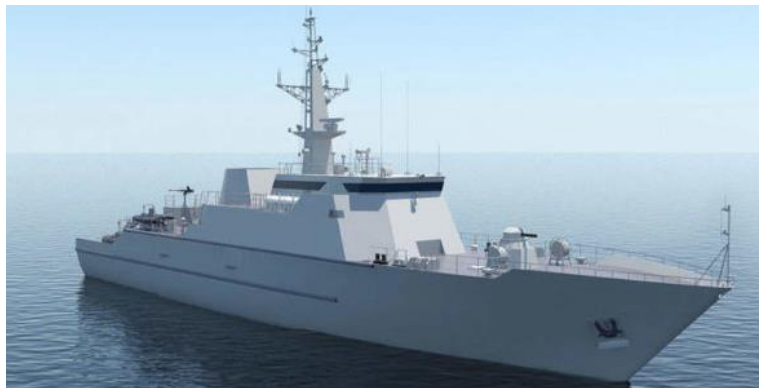
Σχήμα 1.2: Ρωσικό Ναρκοθηρευτικό κατασκευασμένο από σύνθετα υλικά
