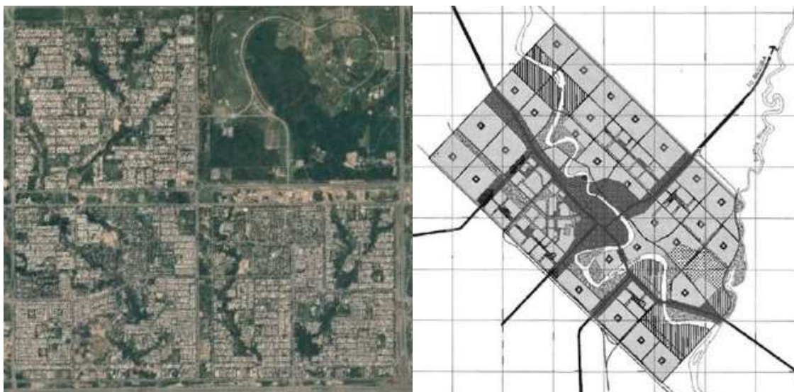
Εικόνα 6 Doxiades Superblocks. Αριστερά, Google Earth Ισλαμαμπαντ, Δεξιά : Δοξιάδης Σχέδιο Βαγδάτης 1958, (πηγή Doxiadis Archives). Το έργο του Δοξιάδη αποτελεί ίσως την επιτομή και το σημείο πτώσης, ταυτόχρονα, των «ορθολογικών» λειτουργικών αναπτύξεων της μοντέρνας πολεοδομίας. Συνδυάζει μοντερνιστική αρχιτεκτονική, χώρους πρασίνου και καλά συνδεδεμένες υποδομές για ένα βιώσιμο και αειφόρο αστικό περιβάλλον, όλα οργανωμένα γύρω από ένα δίκτυο “SuperBlocks”, δηλαδή τετραγώνων 2Χ2 χλμ, τα οποία εντός φιλοξενούν μία εσωτερική «πόλη» που συνδέεται σε παράταξη με τις όμορες της.
