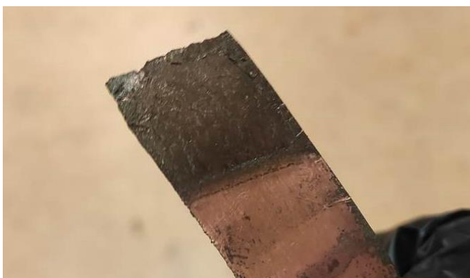
Εικόνα 37 Απόθεση κοβαλτίου πάνω σε φύλλο χαλκού
