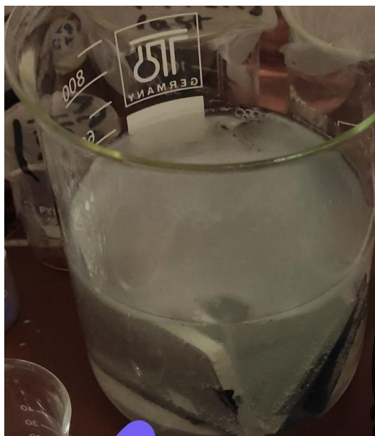
Εικόνα 24 Αποφόρτιση μπαταριών σε διάλυμα χλωριούχου νατρίου.
