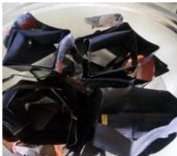
Εικόνα 25 Γλυκό ανόδου - καθόδου μετά την αποσυναρμολόγηση της μπαταρίας.
