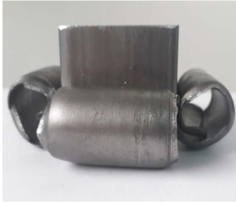
Εικόνα 59 Όψεις κατεστραμμένου δοκιμίου με χρήση μηχανισμού σταυροειδούς trigger με προσανατολισμό
