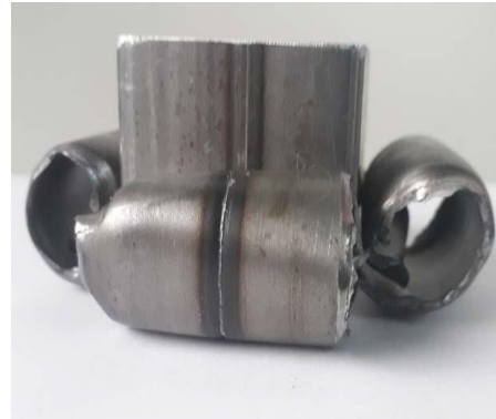
Εικόνα 59 Όψεις κατεστραμμένου δοκιμίου με χρήση μηχανισμού σταυροειδούς trigger με προσανατολισμό
