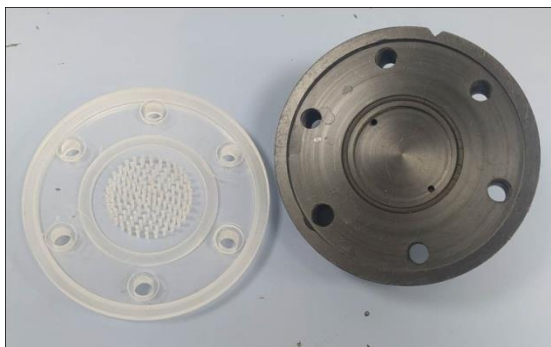
Εικόνα 4.6-4. Μονάδα πίεσης για καθορισμό του LEP κάθε μεμβράνης
