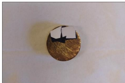
Εικόνα 5.1-2. Τοποθέτηση δειγμάτων σε ορείχαλκο με ταινία άνθρακα διπλής όψεως κατάλληλη για ηλεκτρονική μικροσκοπία σάρωσης
