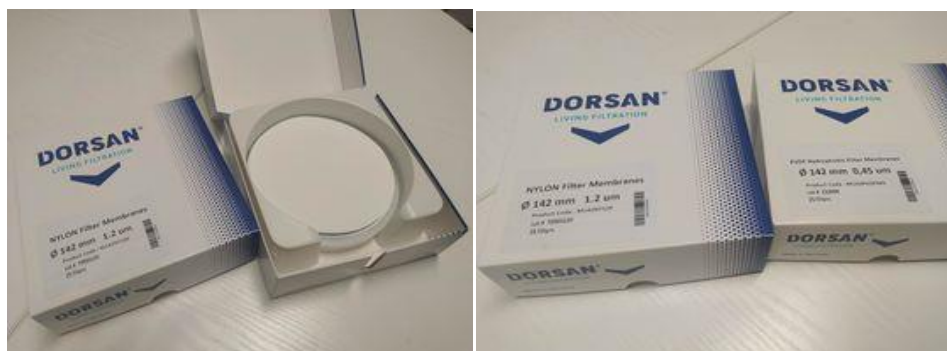
Εικόνα 4.1-1. Κυκλικές μεμβράνες NY και PVDF διαμέτρου 142 mm. Προμηθευτής είναι η Dorsan
