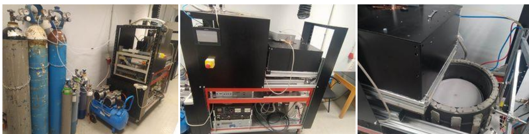
Εικόνα 4.3-1. Αντιδραστήρας πλάσματος (ICP) του Ινστιτούτου Νανοεπιστήμης και Νανοτεχνολογίας
