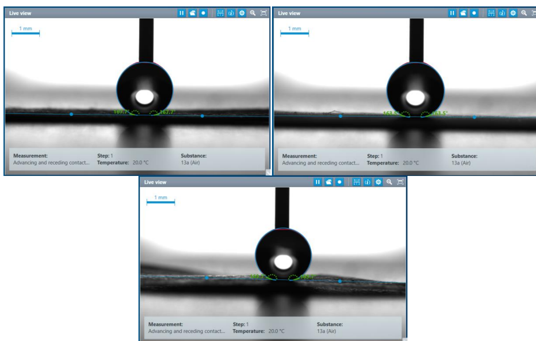
Εικόνα 5.2-1. Γωνίες επαφής επεξεργασμένων μεμβρανών PVDF (αριστερά) , PES (δεξιά) και NY (κάτω) μετά από εγχάραξη με πλάσμα \text{O}_2 και εναπόθεση με πλάσμα \text{C}_4\text{F}_8
