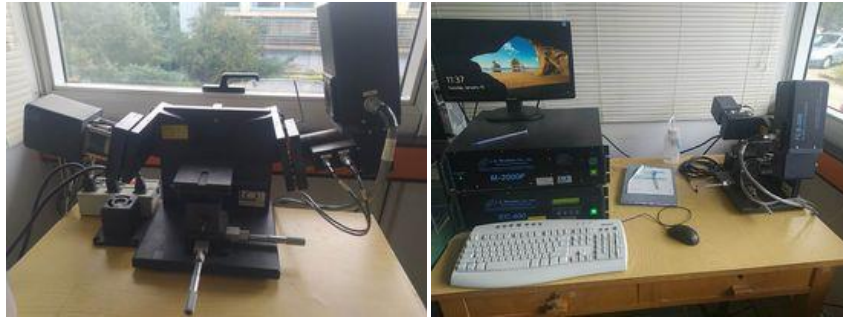
Εικόνα 4.4-1. Πειραματική διάταξη ελλειψόμετρου
