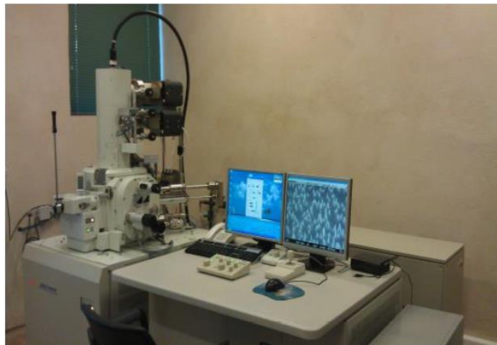
Εικόνα 4.5-1. Μικροσκόπιο σάρωσης ηλεκτρονίων JSM-7401-F που βρίσκεται στο Ινστιτούτο Νανοεπιστήμης και Νανοτεχνολογίας.
