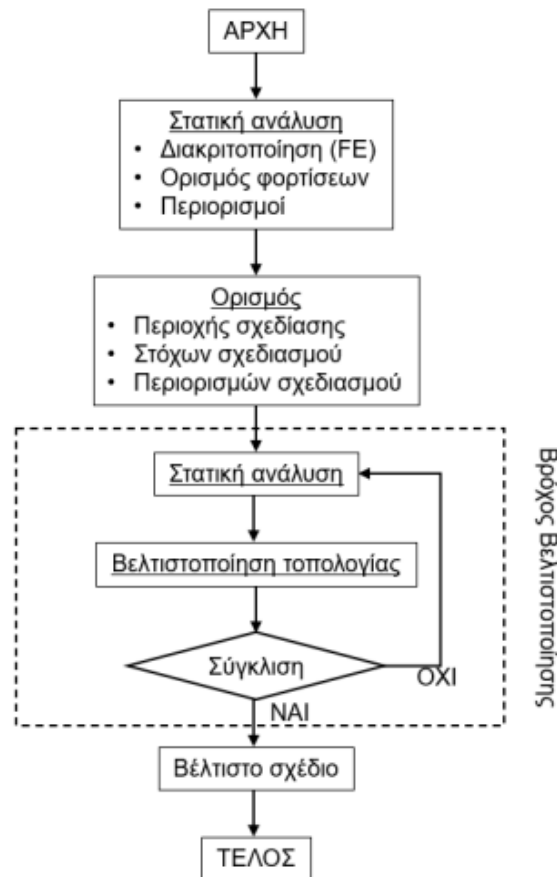
Εικόνα 1.7: Διάγραμμα ροής για την λειτουργία της επαναληπτικής διαδικασίας της τοπολογικής βελτιστοποίησης. [8]
