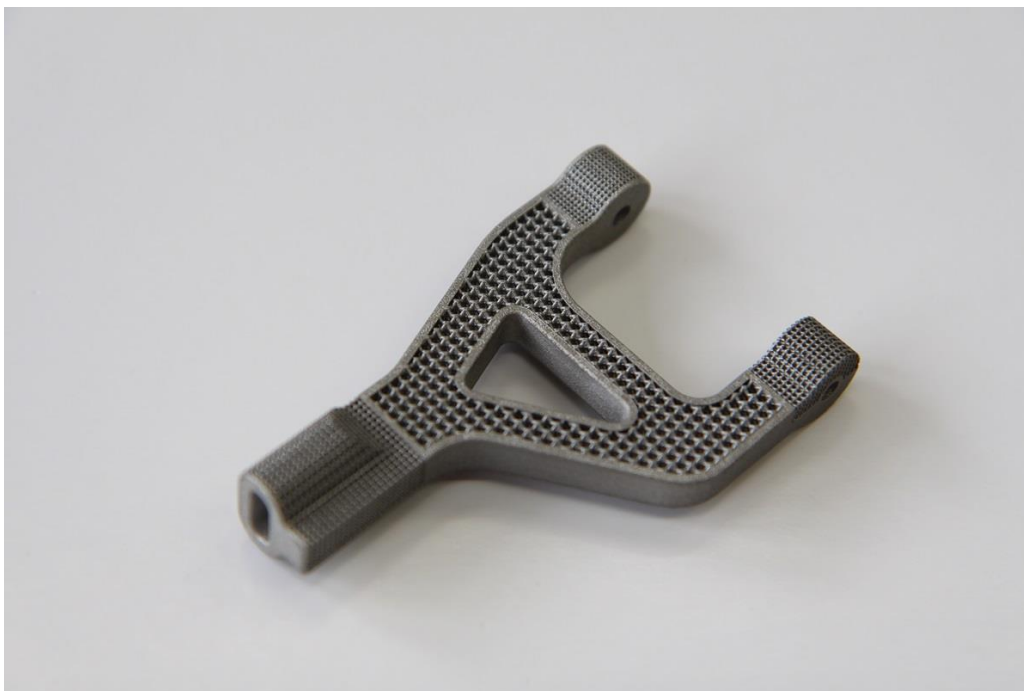
Εικόνα 2.20: Μεταλλικό μηχανολογικό εξάρτημα με πλεγματικές δομές κατασκευασμένο σε τρισδιάστατο εκτυπωτή τύπου SLM . [23]
