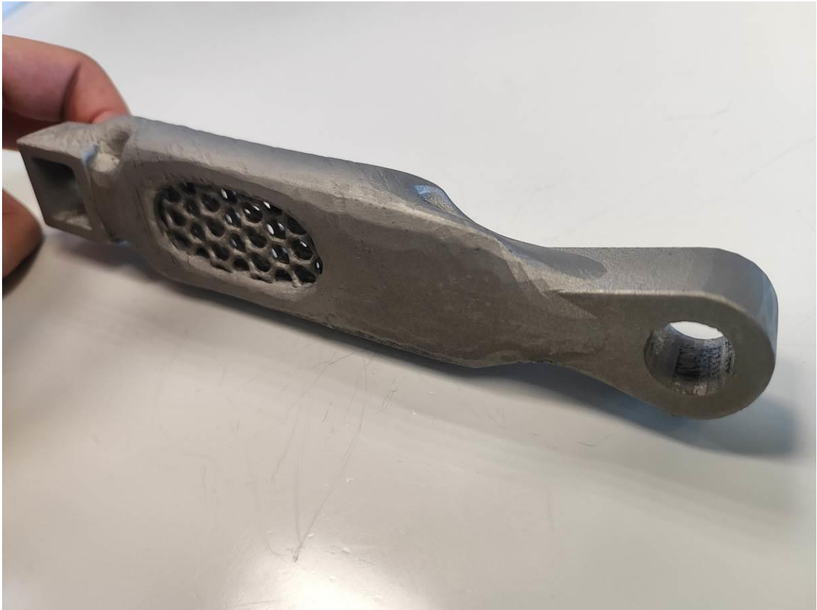
Εικόνα 5.5: Το αποτέλεσμα της κατασκευής από ανοξείδωτο χάλυβα 316.
