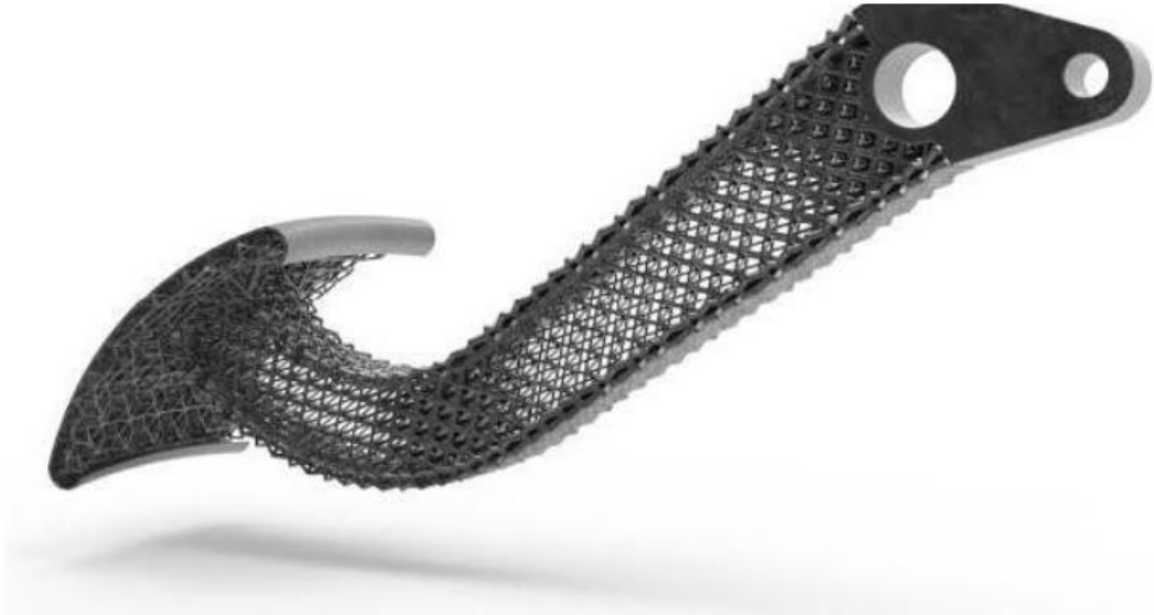
Εικόνα 2.13: Πετάλι αυτοκινήτου σχεδιασμένο στο πρόγραμμα nTopology με χρήση πλεγματικών δομών ακτινών (Beam) . [21]
