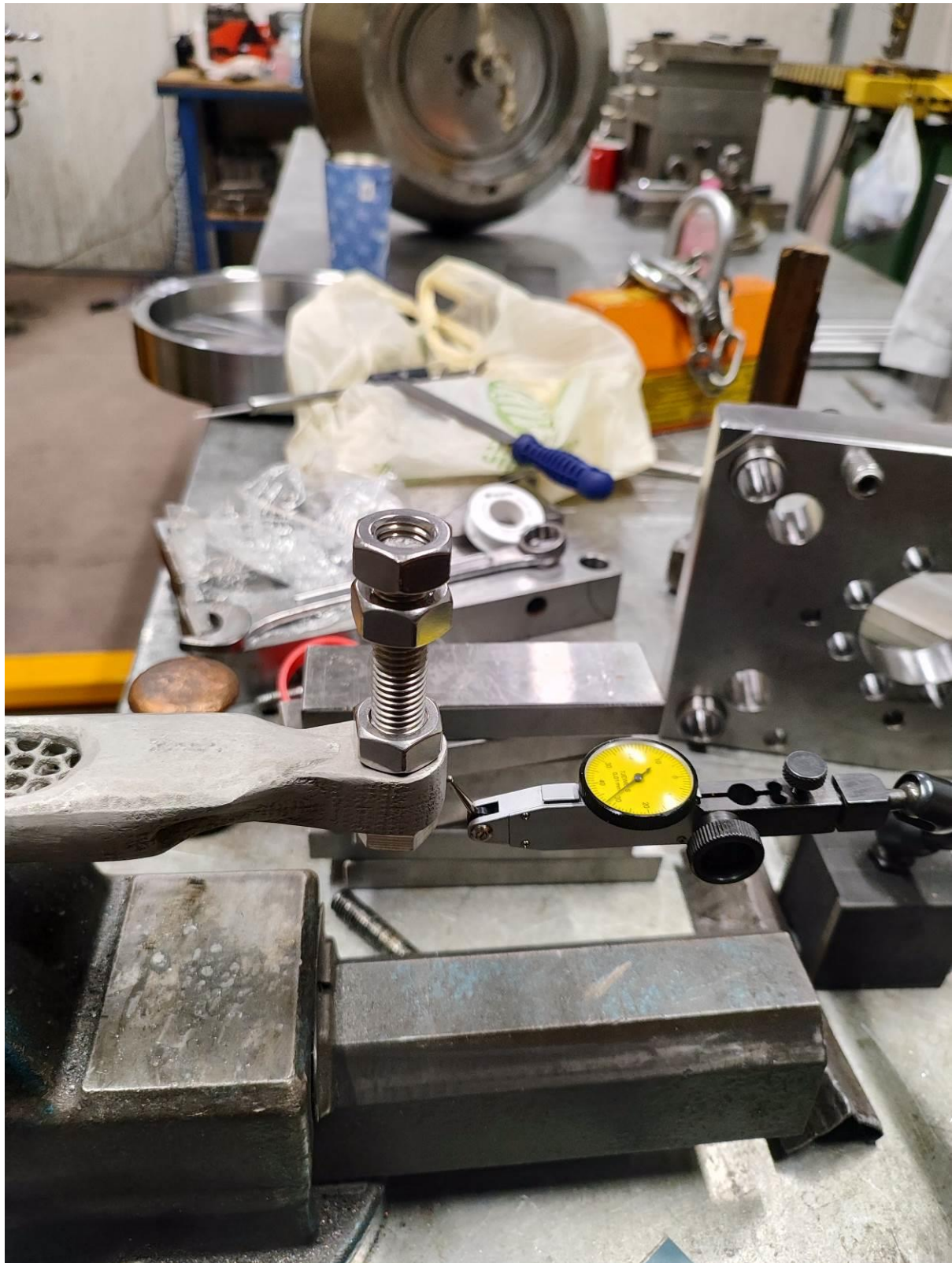
Εικόνα 5.12: Στιγμιότυπο λίγο πριν την άσκηση δύναμης παράλληλα στον άξονα σχεδίασης X.
