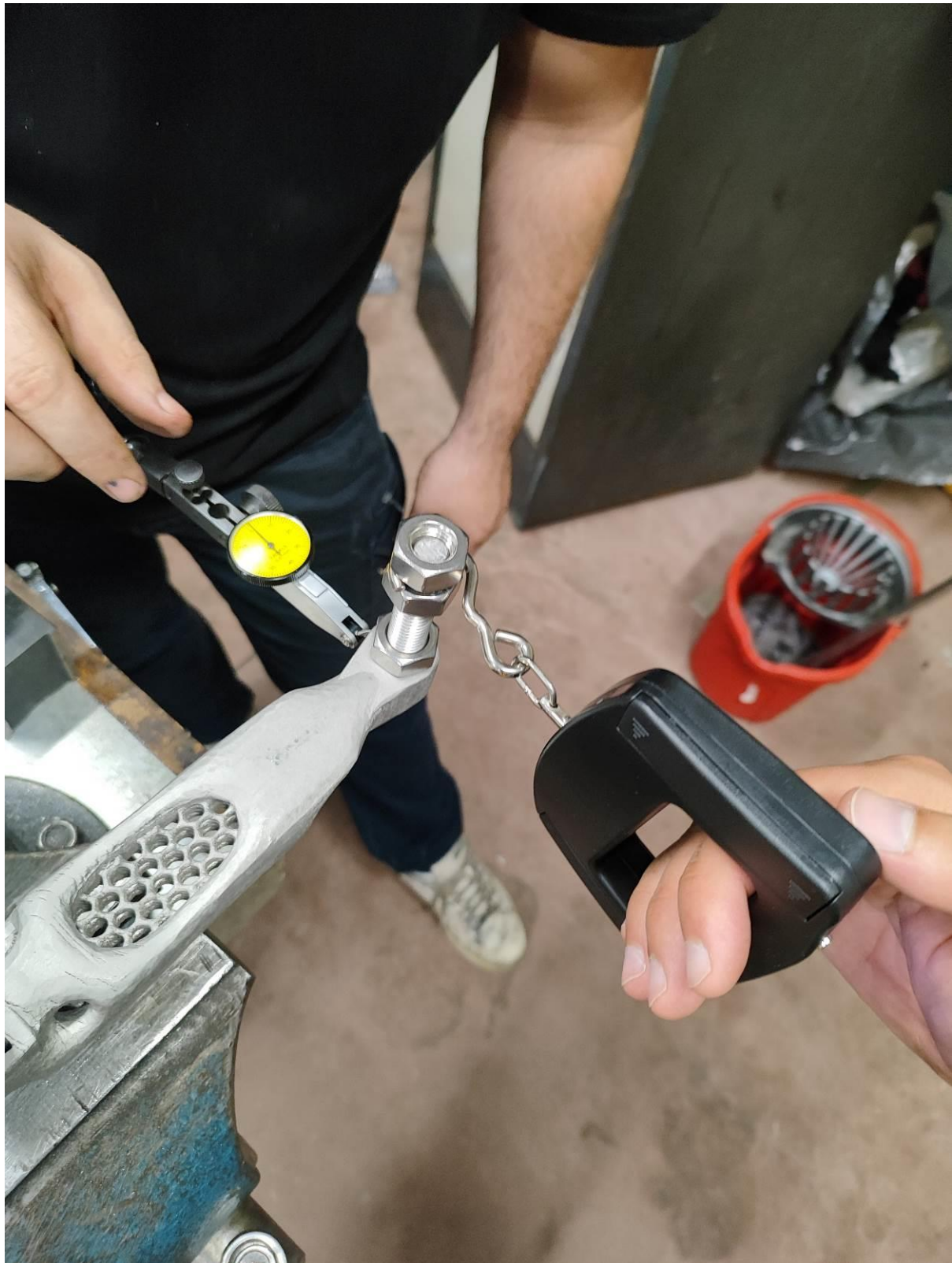
Εικόνα 5.11: Στιγμιότυπο κατά την άσκηση δύναμης κάθετα στον άξονα σχεδίασης X.
