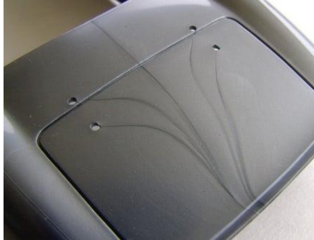
Σχήμα 2.10: Περίπτωση τελικού προϊόντος χύτευσης με ελάττωμα γραμμών ροής (flow lines)
