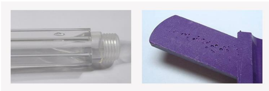
Σχήμα 2.14: Περίπτωση τελικών προϊόντων έγχυσης με ελάττωμα κενών (voids)
