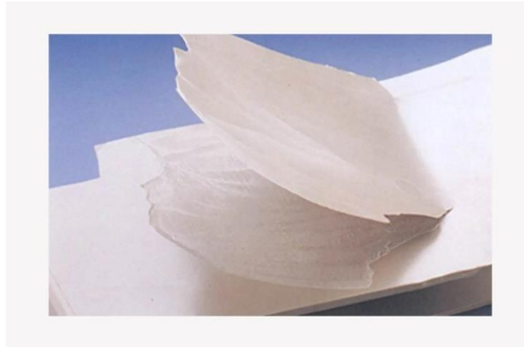
Σχήμα 2.13: Περίπτωση τελικού προϊόντος έγχυσης με ελάττωμα αποκόλλησης (delamination)
