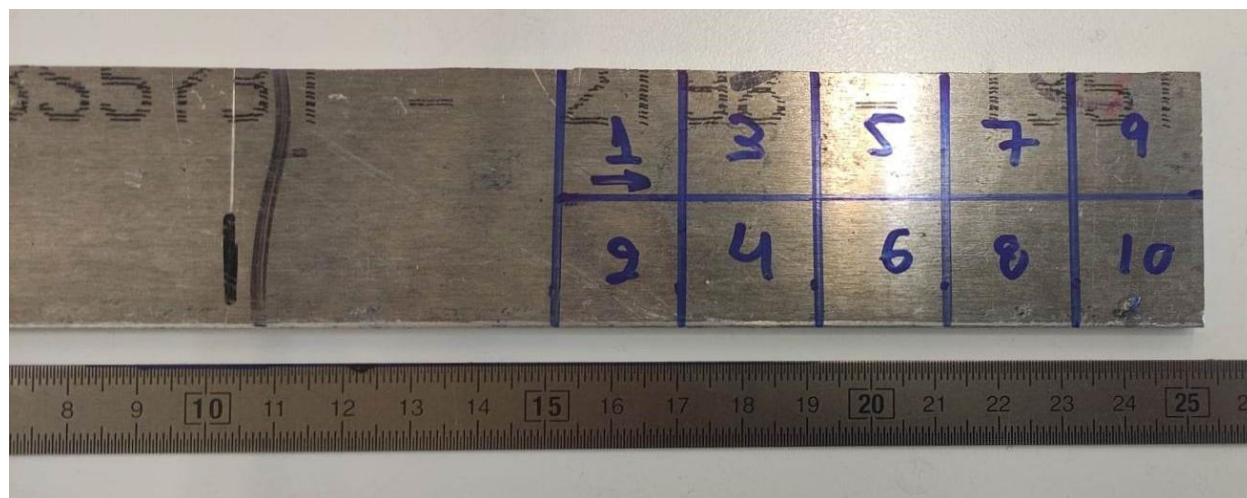
Εικόνα 14. Αρχικό έλασμα AA2198-T351 και μέγεθος δειγμάτων που κόπηκαν.
