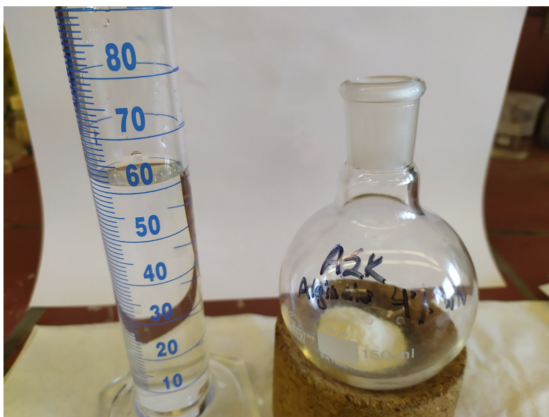
Σχήμα 11.1: Ογκομετρική φιάλη με αλγινικό και ογκομετρικός κύλινδρος με υπερκάθαρο νερό
