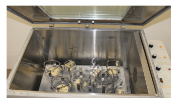
(β') Εσωτερικό συσκευής επωαστήρα
