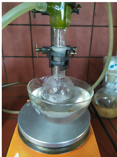
Σχήμα 11.2: Ογκομετρική φιάλη με γλυκόζη και γαλακτικό οξύ τοποθετημένη σε μαγνητικό αναδευτήρα υπό θέρμανση.
