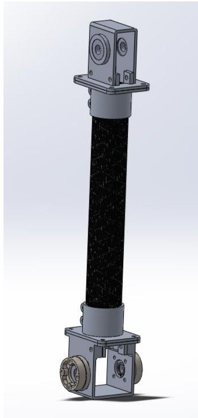
Σχήμα 3-74. Η διαμόρφωση του πρώτου συνδέσμου για την ανάλυση πεπερασμένων στοιχείων.
