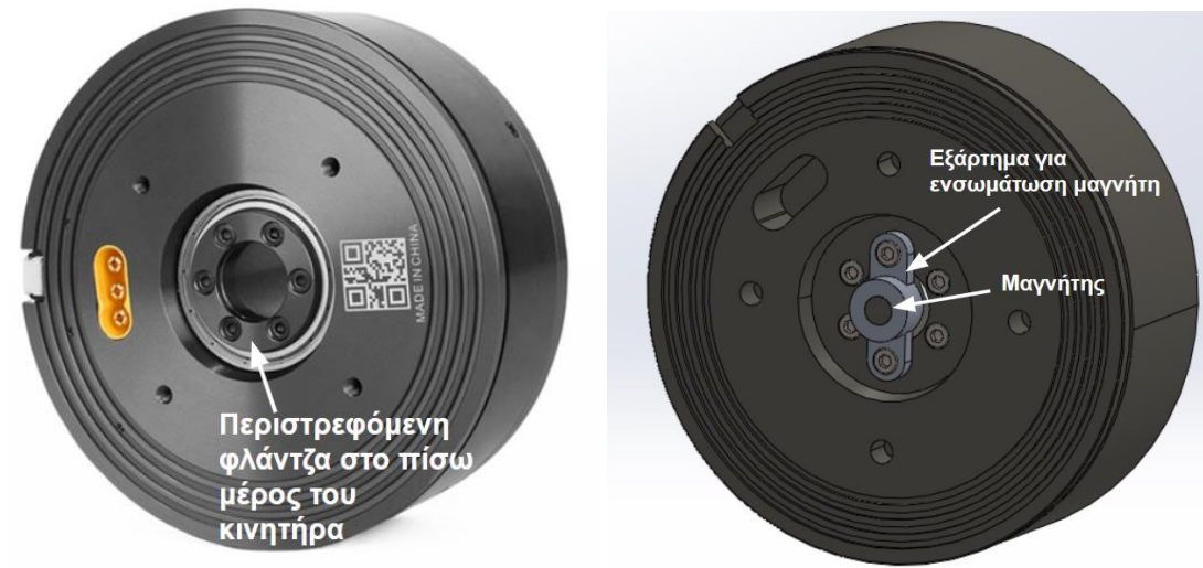
Σχήμα 3-12. Ο τρόπος πρόσδεσης του μαγνήτη του αισθητήρα γωνιακής θέσης στον κινητήρα. Πηγή εικόνας (αριστερά): [28].
