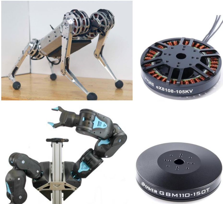
Σχήμα 3-1. (Πάνω) Το ρομπότ MIT Mini Cheetah και ο κινητήρας των επενεργητών του, iFlight ex-8. (Κάτω) Ο ρομπωτικός χειριστής BLUE και ο κινητήρας των επενεργητών του, iPower GBM110. Πηγές εικόνων: [15] [26] [4] [27].
