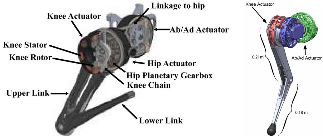
Σχήμα 2-11. Συστήματα με σειριακή διάταξη κινητήρων, με τον επενεργητή του αγκώνα (εδώ γονάτου (knee actuator)) τοποθετημένο κοντά στη βάση. Φαίνονται τα πόδια (αριστερά) του MIT Cheetah 3 και του Mini Cheetah του MIT. Πηγές εικόνων: [18] [15].
