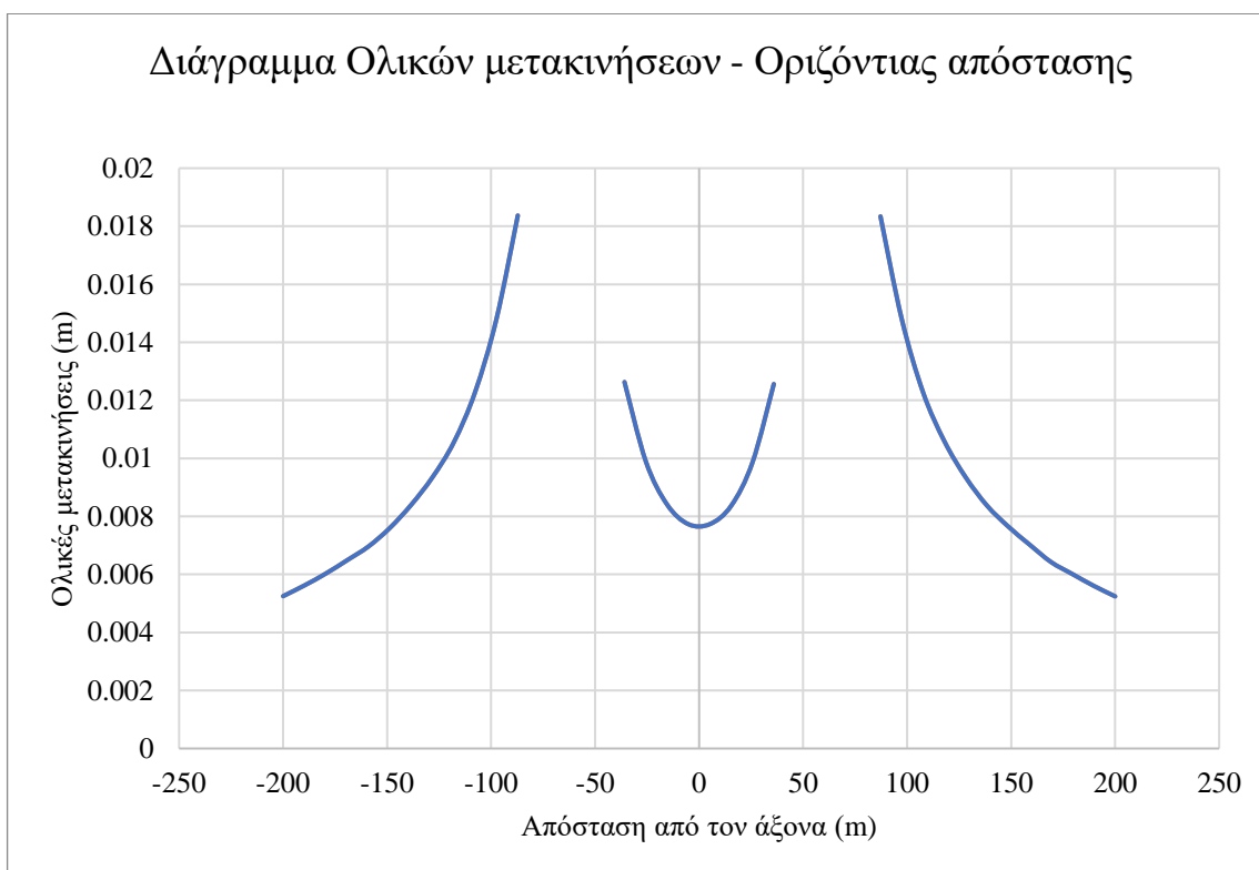
Εικόνα 50: Διάγραμμα ολικών μετατοπίσεων συναρτήσει της οριζόντιας απόστασης από τον άξονα της μονάδας αποθήκευσης
