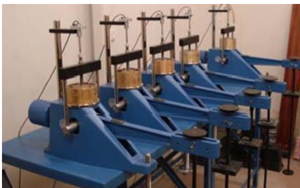
Εικόνα 3. Σκαρίφημα της δοκιμής συμπίεσιόμετρου (αριστερά) και η διάταξη στο εργαστήριο (δεξιά)
