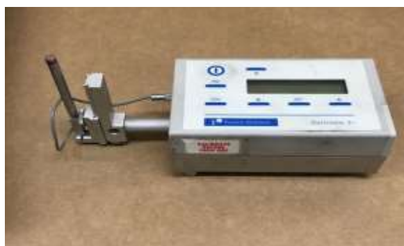
Εικόνα 31: Taylor Hobson Surtronic 3+ Προφιλόμετρο
