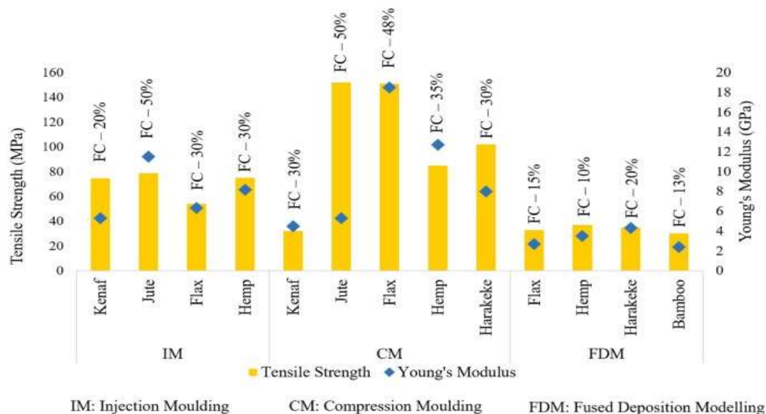
Εικόνα 9. Αντοχή σε εφελκυσμό έναντι του συντελεστή Young ασυνεχούς ενίσχυσης βιοπροερχόμενων από ίνες/σύνθετα υλικά PLA (31).
