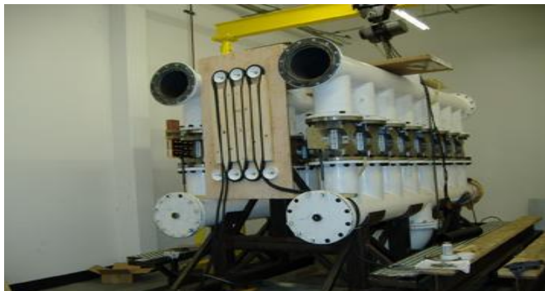
Εικόνα 3.3.5.: Το υπό ανάπτυξη εργαστηριακό πρωτότυπο SARA MWEC των 100kW. Πηγή: http://www.sara.com/RAE/ocean_wave.html
