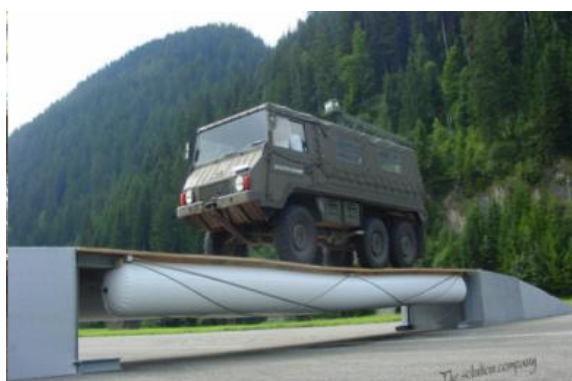
Εικόνα 3.2.10.: Επίδειξη της αντοχής των θαλάμων αέρα του μετατροπέα WaveBlanket Πηγή: www.windwavesandsun.com
