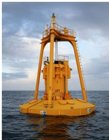
Εικόνα 3.2.9.: Η συσκευή Power Buoy PB150 σε λειτουργία στο Orkney Isles της Σκωτίας. Πηγή: www.oceanpowertechnologies.com
