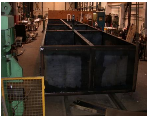
Εικόνα 3.3.7.: Το μοντέλο WaveMaster των 20 μέτρων υπό κατασκευή και ένα πειραματικό μοντέλο WaveMaster μικρής κλίμακας σε δοκιμή σε δεξαμενή δημιουργίας τεχνητών κυμάτων.
