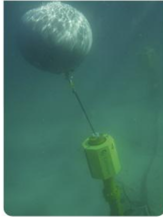
Εικόνα 3.5.3.: Υπεράκτια μονάδα CETO σε λειτουργία στη Fremantke στην Δυτική Αυστραλία.
