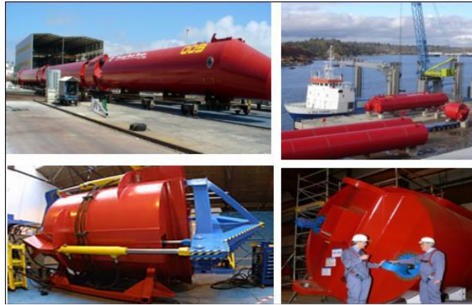
Εικόνα 3.1.6.: Φωτογραφίες από τα διάφορα στάδια κατασκευής και μεταφοράς του μετατροπέα Pelamis 2 συνολικής ισχύος 750kW. Πηγή: www.pelamiswave.com
