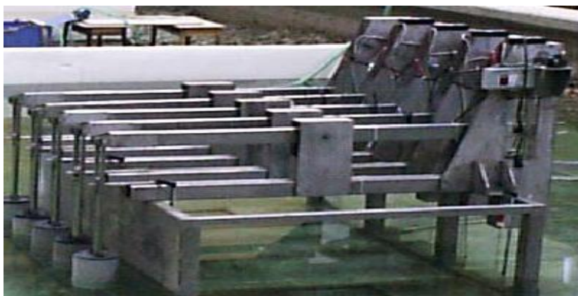
Εικόνα 3.2.4.: Το δοκιμαστικό μοντέλο κλίμακας 1:15 εμπρός του κυματοθραύστη σε δεξαμενή δημιουργίας τεχνητών κυμάτων στο Μετσόβιο Πολυτεχνείο. Πηγή: www.cres.gr/kape
