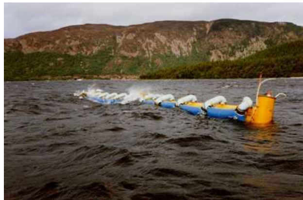
Εικόνα 3.1.4.: Δοκιμή της συσκευής SEA Clam στη λίμνη Loch Ness Πηγή: www.sealtd.co.uk
