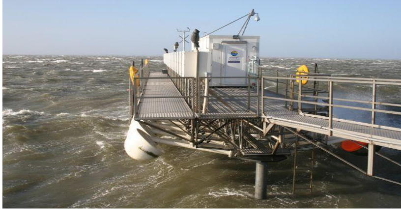
Εικόνα 3.2.8.: Το μοντέλο Wave Star κλίμακας 1:10 στο Nissum Bredning της Δανίας. Διακρίνονται οι σημαδούρες σε ανυψωμένη θέση εκτός λειτουργίας. Πηγή: www.wavestarenergy.com
