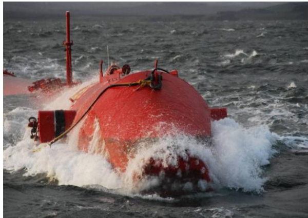
Εικόνα 3.1.5.:Το πρωτότυπο μοντέλο Pelamis 1 φυσικής κλίμακας σε λειτουργία. Πηγή: www.pelamiswave.com
