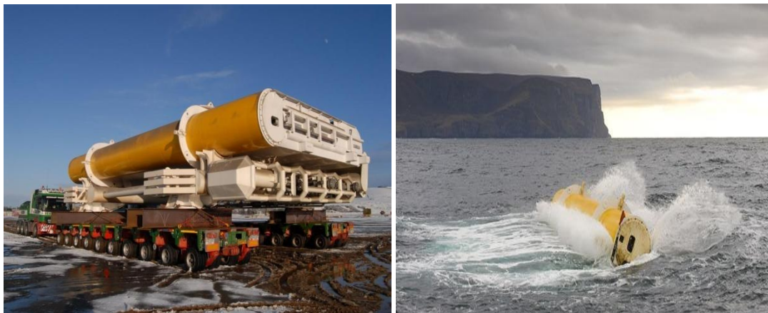
Εικόνα 3.4.2.: α) Μεταφορά συσκευής Oyster σε πραγματικό μέγεθος και β) σε λειτουργία. Πηγή: www.aquamarinepower.com
