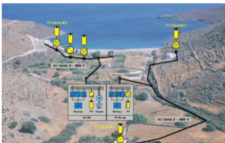
Εικόνα 35: Η εγκατάσταση του μικροδικτύου στη Κύθνο.
