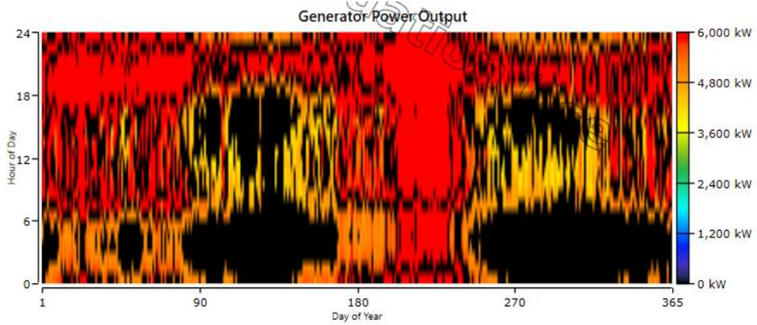
Εικόνα 72: Παραγόμενη Ισχύς από τα ήδη εγκατεστημένη συμβατική μονάδα Wartsila NSD18 (6,514 MW) 1 κατά την διάρκεια του έτους
