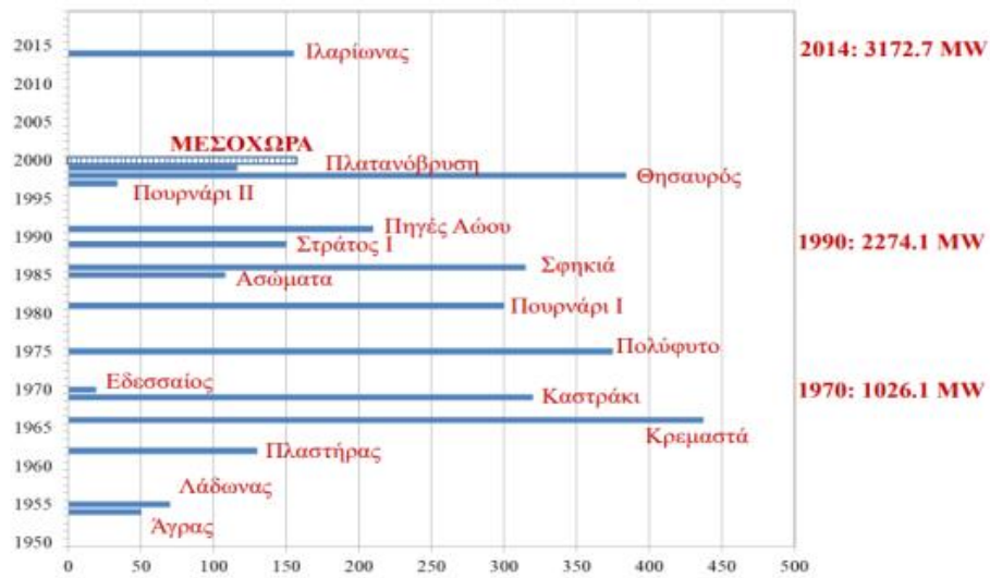
Εικόνα 27: Εξέλιξη ανά 5-ετία της εγκατεστημένης ισχύς των ΥΗΣ στην Ελλάδα Πηγή: https://www.dei.gr
