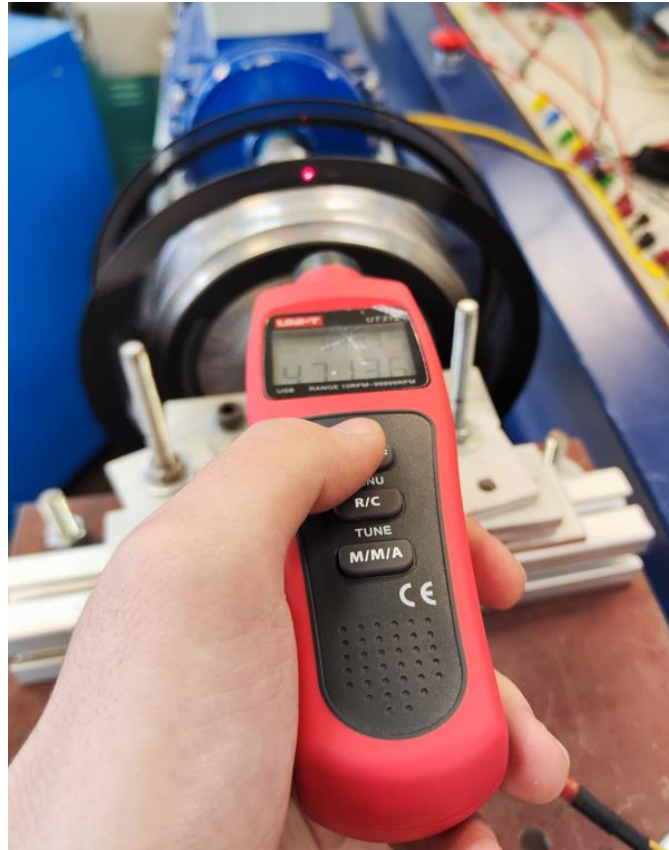
Σχήμα 4. 8. Χρήση του οπτικού ταχυμέτρου UNI-T UT373 για την μέτρηση των στροφών της γεννήτριας.
