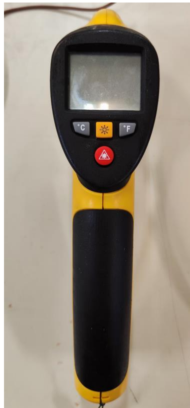
Σχήμα 4. 10. Το θερμόμετρο υπέρυθρων ακτινών C.A 879 της Chauvix Arnoux.
