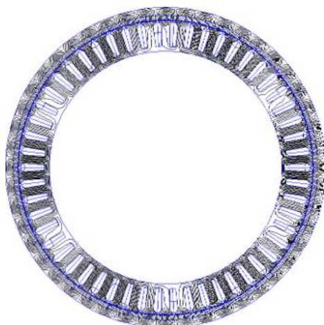
Σχήμα 8. 11. Η ροή του μαγνητικού πεδίου στον Κινητήρα 51.
