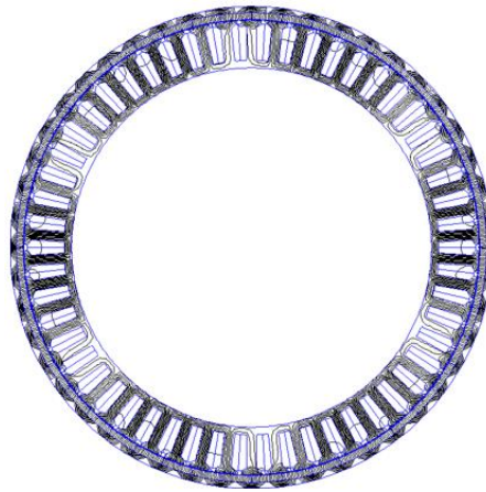
Σχήμα 8. 9. Η ροή του μαγνητικού πεδίου στον Κινητήρα 13.
