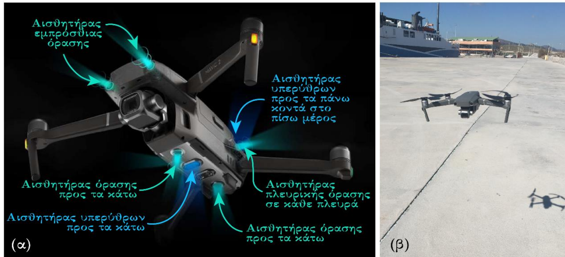
Εικόνα 14 – (α) Η τεχνολογία ανίχνευσης εμποδίων (αισθητήρες) του MAVIC 2 Pro Πηγή: (Corrigan, 2020) (β) UAV MAVIC 2 στο πεδίο Pro Πηγή: Εργαστήριο Λιμενικών Έργων ΕΜΠ
