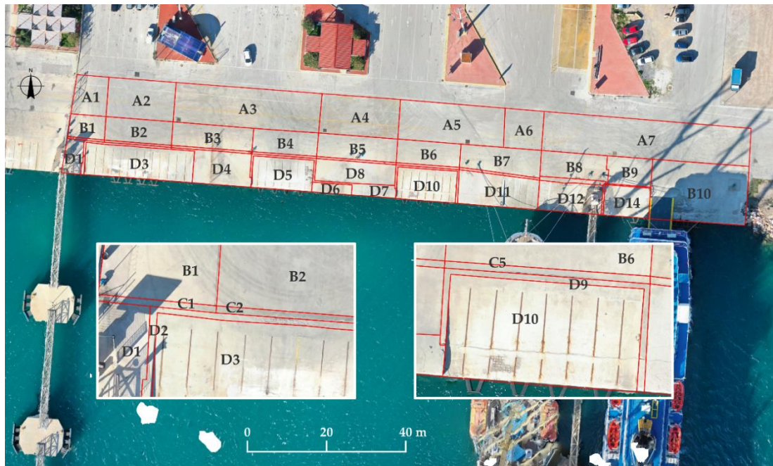
Εικόνα 26 – Οριοθέτηση πλακών σκυροδέματος της περιοχής μελέτης
