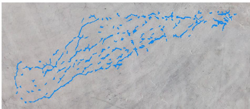
Εικόνα 50 – Οπτικοποίηση εντοπισμένων ρωγμών με χρώμα σε κάθε εικόνα/λήψη
