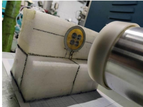
Εικόνα 2.10: Διάταξη της μέτρησης της αποδιέγερσης των στόχων που ακτινοβολήθηκαν με ενέργεια νετρονίων E_n = 18.0 \text{ MeV} στον ανιχνευτή A HPGe (80%) (αριστερά) και στον ανιχνευτή B HPGe (80%) (δεξιά)
