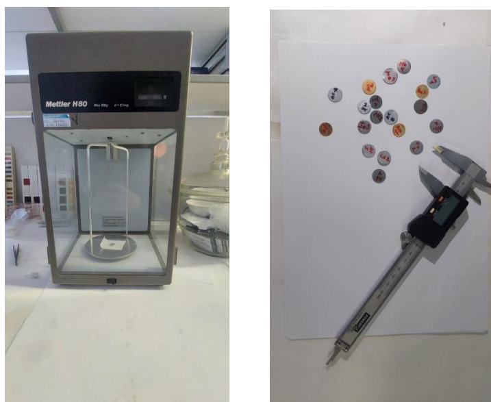
Εικόνα 2.5: Ζύγιση στόχων (αριστερά), Παχύμετρο με το οποίο μετρήθηκαν οι στόχοι (δεξιά)
