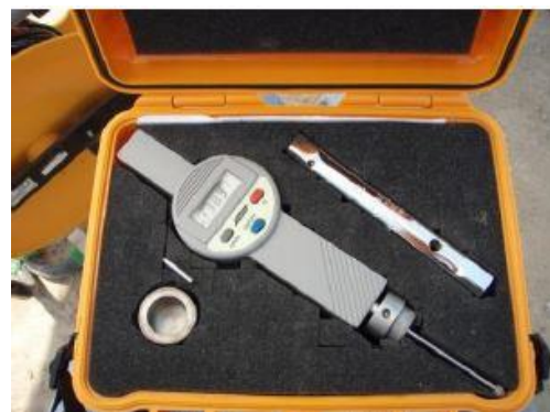
Εικόνα 3-11. Όργανο χειροκίνητης μέτρησης μετατόπισης ράβδου σε εκτασίμετρο (Lunardi)
