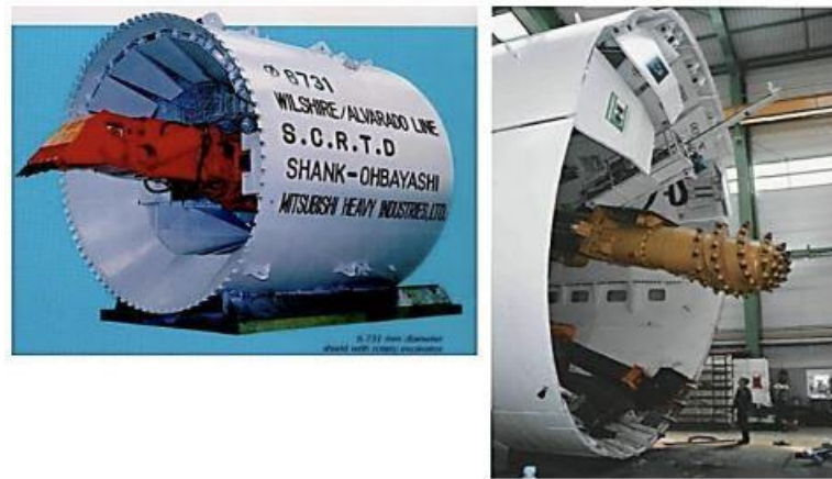
Εικόνα 2-8: Ασπίδες SM – T2, με βραχίονα εκσκαφέα και βραχίονα φρέζας διαμέτρου 9495mm που χρησιμοποιήθηκε για τη διάνοιξη 1911 m στη γραμμή 2 του μετρό της Αθήνας (Σοφιανός, Α.2018)
