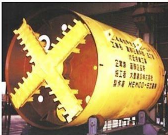
Εικόνα 2-10: Ασπίδα εδαφικής πίεσης για την ευστάθεια μετώπου, Katsushika Ward, Tokyo, 1976 (jsce, 2001)
