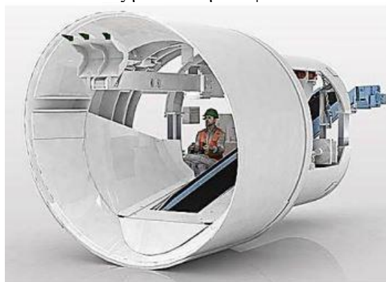
Εικόνα 2-7: Μηχανή μερικής κοπής με ασπίδα SM – T1 (Σοφινός, Α. 2018)
