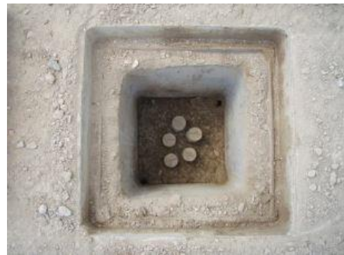
Εικόνα 3-10. Ανοιχτό φρέατο εκτασίμετρων 5 κεφαλών (Lunardi).
