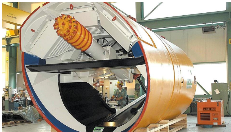
Εικόνα 2-6: Μηχάνημα μερικής μετωπικής κοπής χωρίς την εφαρμογή υποστήριξης (Σοφιανός, Α. 2018)
