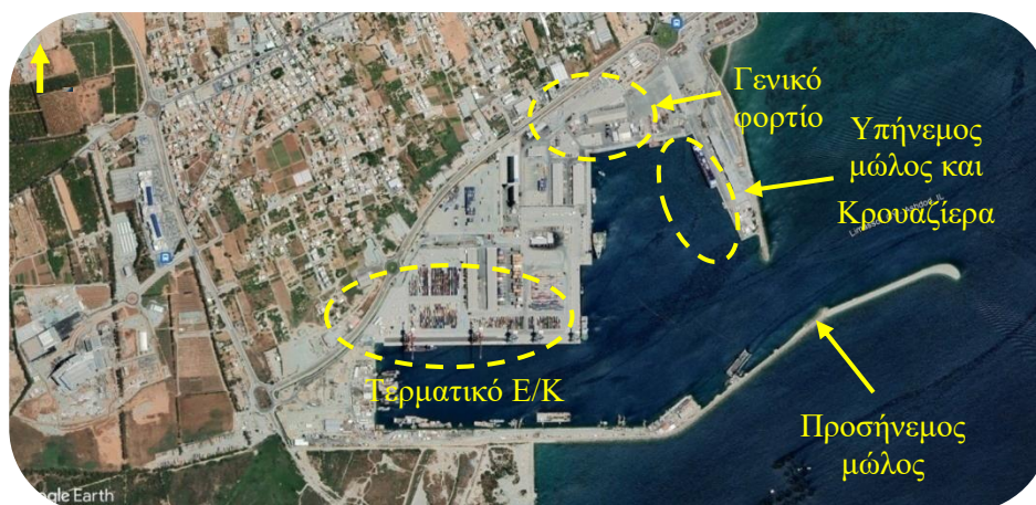
Χάρτης 5.2: Γενική άποψη υφιστάμενων λιμενικών εγκαταστάσεων λιμένα Λεμεσού (Πηγή: Google Earth, ίδια επεξεργασία)
