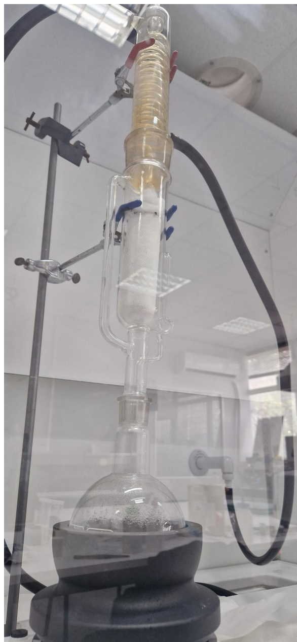
Σχήμα 2.1: Καθαρισμός μέσω της διαδικασίας εκχύλισης Soxhlet
