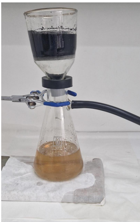
Σχήμα 2.2: Επαναλαμβανόμενες εκπλύσεις και διηθήσεις των CNTs.
