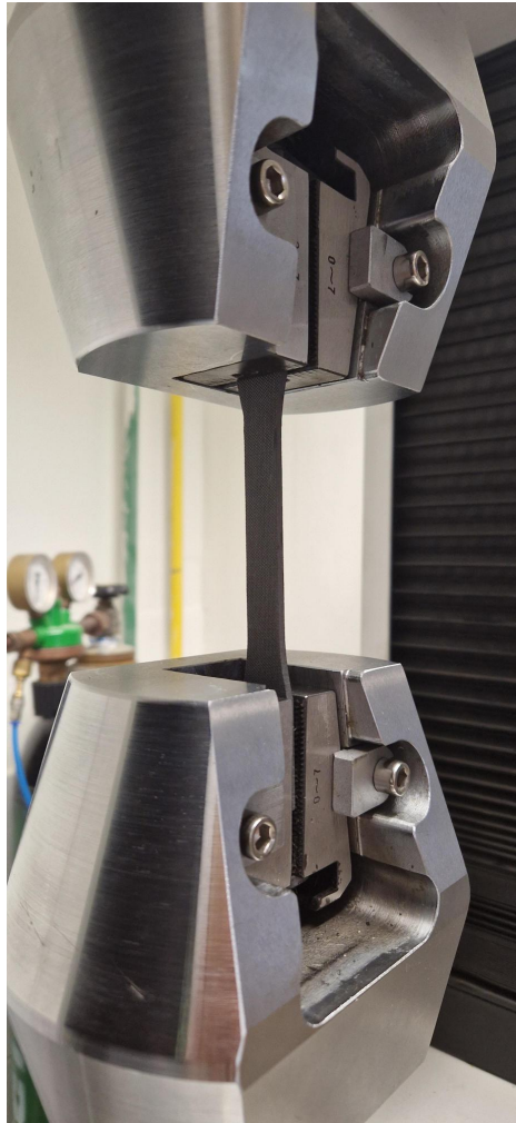
Σχήμα 2.8: Δοκίμιο τοποθετημένο στο μηχάνημα
