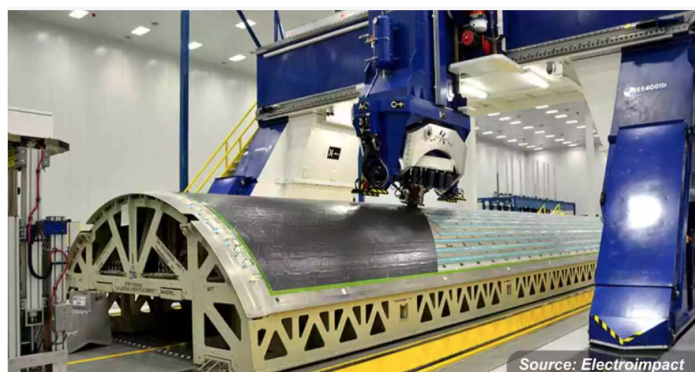
Σχήμα 1.11: Αυτοματοποιημένη τοποθέτηση ταινίας και Αυτοματοποιημένη τοποθέτηση νών (ATL and AFP) [15].
