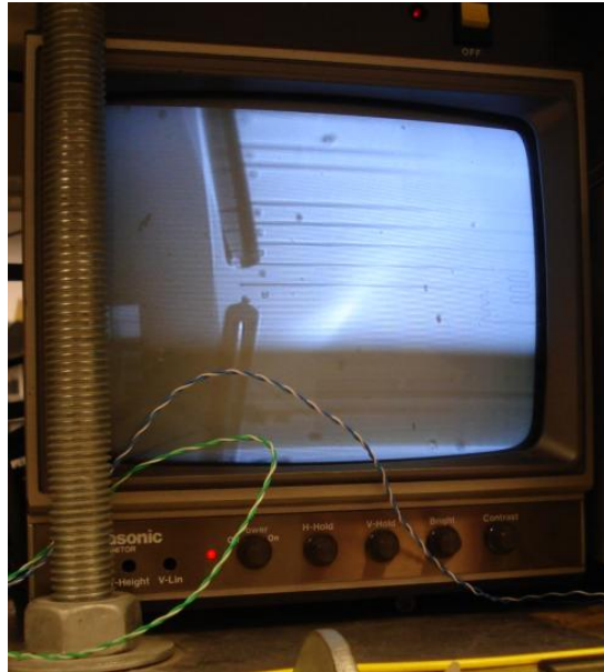
Εικόνα 4.3-Φωτογραφία της οθόνης της IR camera: Οπτική ίνα εισόδου και κυματοδηγός Si
