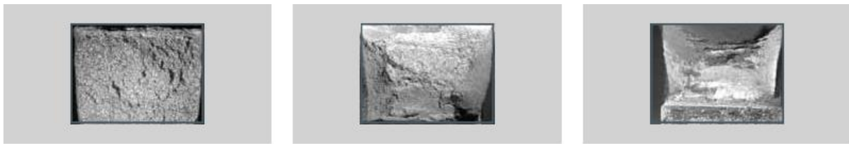
Εικόνα 70: Επιφάνειες θραύσης: α) θραύση μικρής παραμόρφωσης, β) μεικτή θραύση, γ) όλκιμη θραύση [35]
