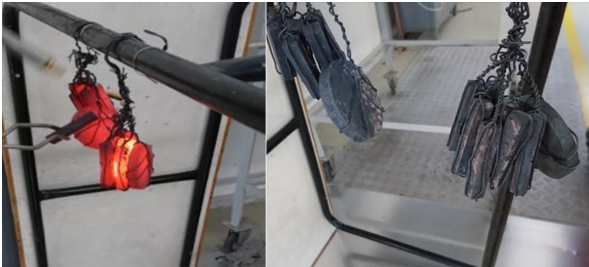
Εικόνα 62: Δοκίμια 1-14 πριν και μετά την βαφή αντίστοιχα.
