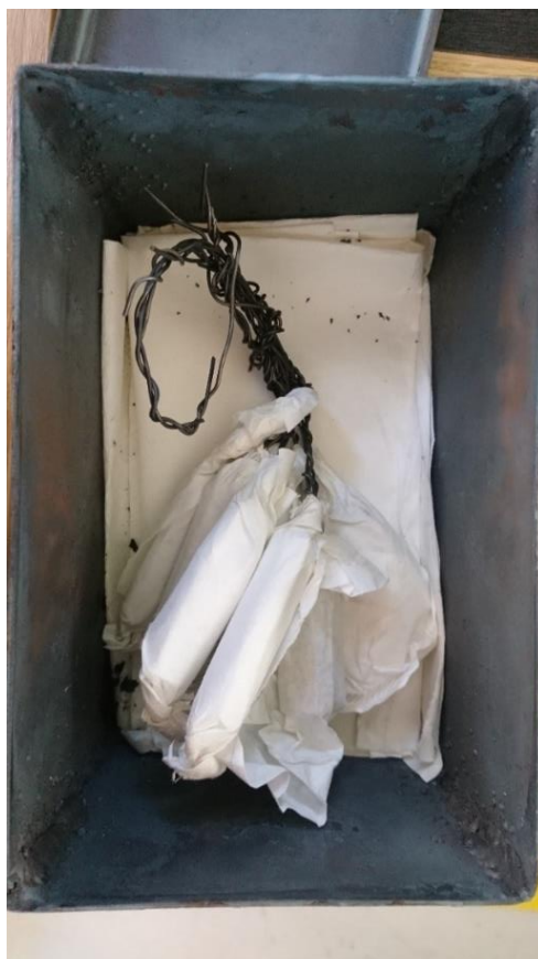
Εικόνα 61: Τα δοκίμια 15-21 τυλιγμένα με διηθητικό χαρτί στο κουτί που θα εισέλθει στο θάλαμο ωστενιτοποίησης
