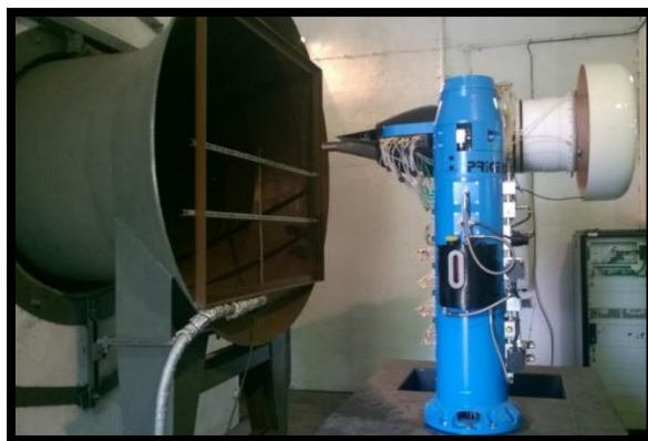
Εικόνα 1-5 : Πειραματική διάταξη ανάλυσης βιοκαυσίμου (Πηγή: Performance and Emissions of a Microturbine and Turbofan Powered by Alternative Fuels)
