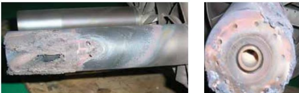
Εικόνα 3.3 – Ζημιά σε ακροφύσιο αεριοστροβίλου λόγω flame holding event [28]
