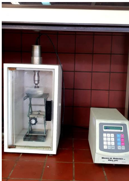
Εικόνα 3.1: Διάταξη συσκευής υπερήχων ((Vibra Cell VCX 400)
