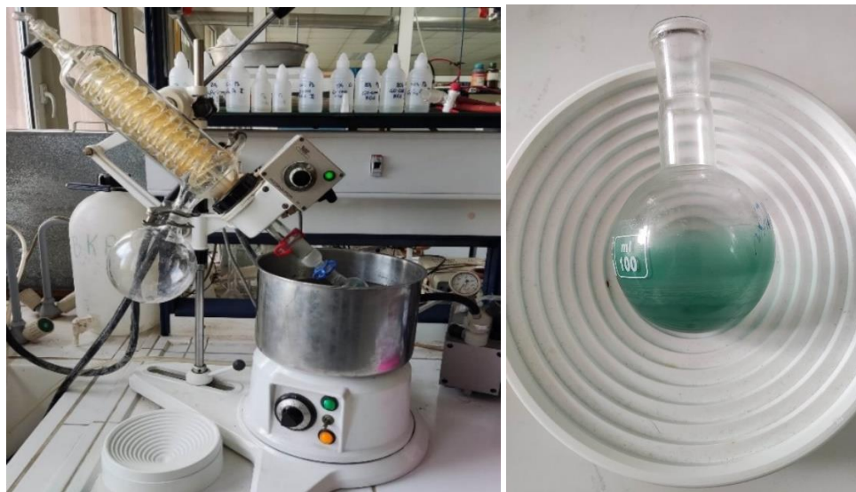
Εικόνα 4.23: Ο περιστροφικός εξατμιστήρας ROTAVAPOR- R (αριστερά) και η σφαιρική φιάλη με το υβριδικό υλικό και τη ZnPc που δε συνδέθηκε (δεξιά).
