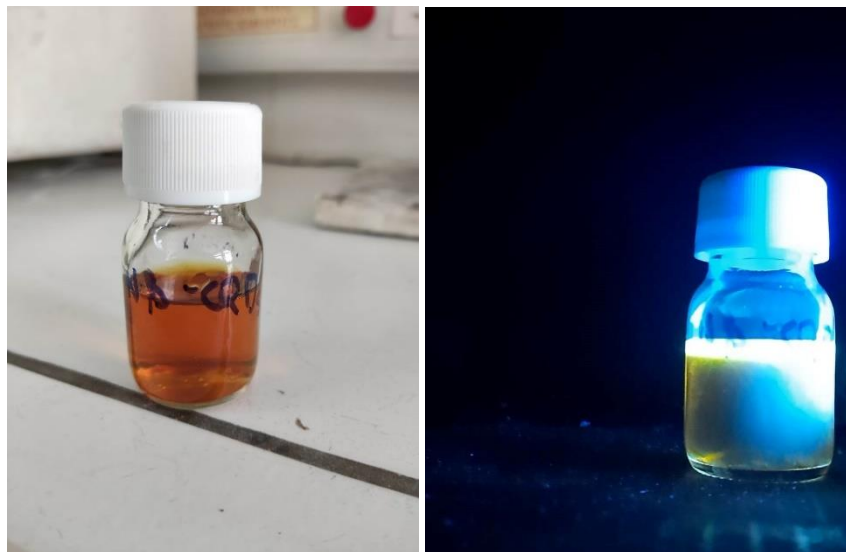
Εικόνα 4.7: Οι (N,B)CQDs σε ορατό φως (αριστερά) και σε υπεριώδες φως 365nm (δεξιά).
