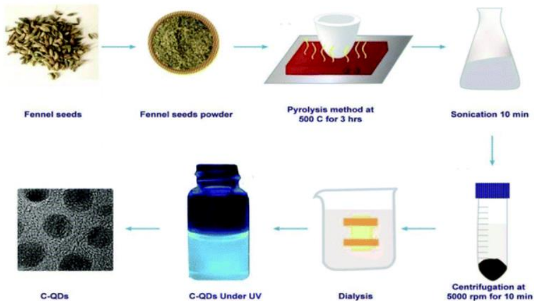
Εικόνα 2.8: Σύνθεση CQDs από σπόρους μάραθου με τη μέθοδο της πυρόλυσης. 36
