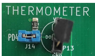
Εικόνα 76 Κύκλωμα DS18B20 και σύνδεση του αισθητήρα στο ntuAboard
