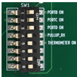
Εικόνα 57 Διακόπτες dip switch στο ntuAboard
