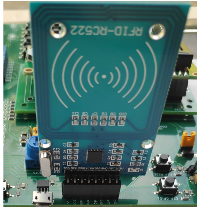
Εικόνα 82 Σύνδεση του RC522 RFID στο ntuAboard
