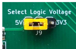
Εικόνα 55 Βραχυκυκλωτήρας για επιλογή V_{Logic} 5V στο ntuAboard
