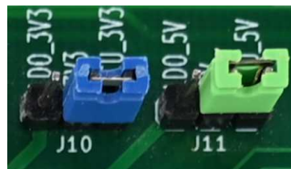
Εικόνα 74 Βραχυκυκλωτήρες για επιλογή τροφοδοσίας στο ntuAboard
