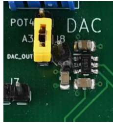
Εικόνα 67 Κύκλωμα DAC5571 στο ntuAboard
