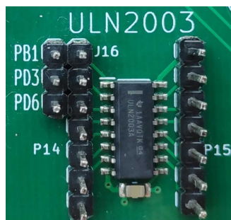
Εικόνα 69 Κύκλωμα του ULN2003 στο ntuAboard
