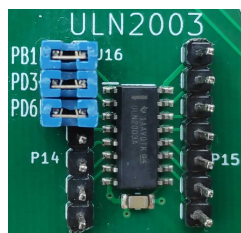
Εικόνα 70 Σύνδεση βραχυκυκλωτήρων στο ULN2003
