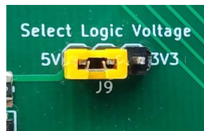
Εικόνα 73 Βραχυκυκλωτήρας για επιλογή VLOGIC 5V στο ntuAboard
