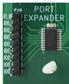
Εικόνα 61 Κύκλωμα PCA9555 στο ntuAboard
