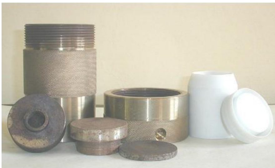
Εικόνα 4.2 Το αυτόκλειστο δοχείο που χρησιμοποιείται. [13]
