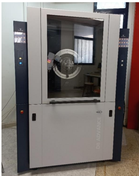
Εικόνα 5.11 Περιθλασίμετρο ακτίνων X Bruker D8 Advance. (Σχολή Χημ./Μηχ., ΕΜΠ).
