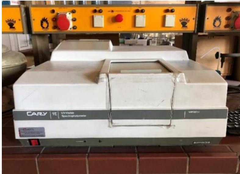
Εικόνα 5.16 Φασματοφωτόμετρο Cary 1E UV/Vis της Varian (Σχολή Χημ./Μηχ., ΕΜΠ).
