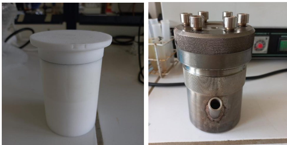
Εικόνα 5.4 Το δοχείο από Teflon και το αυτόκλειστο δοχείο μέσα στο οποίο τοποθετείται το μίγμα που απαιτείται για τη σύνθεση των τελειών άνθρακα.
