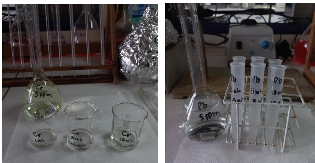
Εικόνα 5.8 Τα υδατικά διαλύματα Pb 5 ppm και Cr 5ppm που παρασκευάστηκαν.
