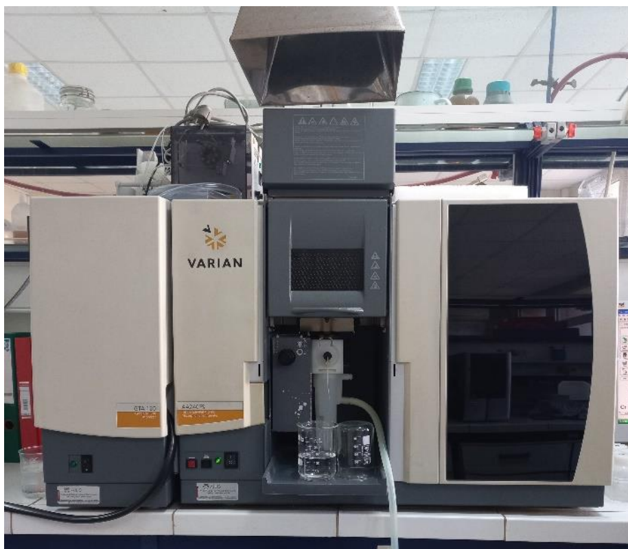
Εικόνα 5.15 Συσκευή FAAS AA240FS της Varian (Σχολή Χημ./Μηχ., ΕΜΠ).
