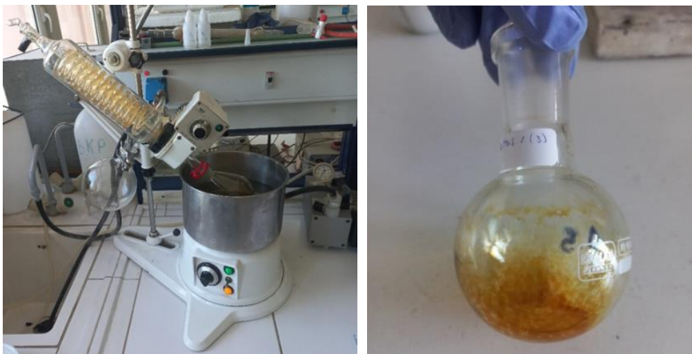
Εικόνα 5.7 Εξάτμιση ποσότητας διαλύματος τελειών άνθρακα, με χρήση περιστροφικού εξατμιστήρα κενού.
