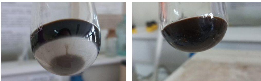
Εικόνα 5.2 Διαδοχικές φυγοκεντρίσεις με απιονισμένο νερό προκειμένου να απομακρυνθεί το λευκό άλας από το ίζημα.
