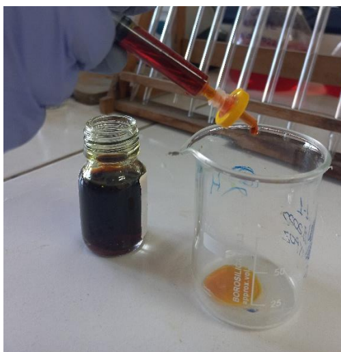
Εικόνα 5.5 Φιλτράρισμα διαλύματος τελειών άνθρακα που λαμβάνεται μετά από την υδροθερμική κατεργασία, χρησιμοποιώντας 0,22 μm φίλτρο σύριγγας PES.
