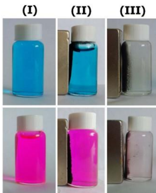
Εικόνα 4.1 Διαλύματα μπλε του μεθυλενίου και ροδαμίνης β πριν (I) και μετά (III) την προσθήκη νανοσωματιδίων Fe 3 O 4 . [29]
