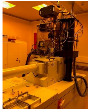
Εικόνα 4.2: α) Αντιδραστήρες LPCVD και β) λιθογραφία ηλεκτρονικής δέσμης
