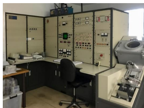
Εικόνα 4.1: α) Χημική εστία του καθαρού χώρου και β) ιοντικός εμφυτευτής
