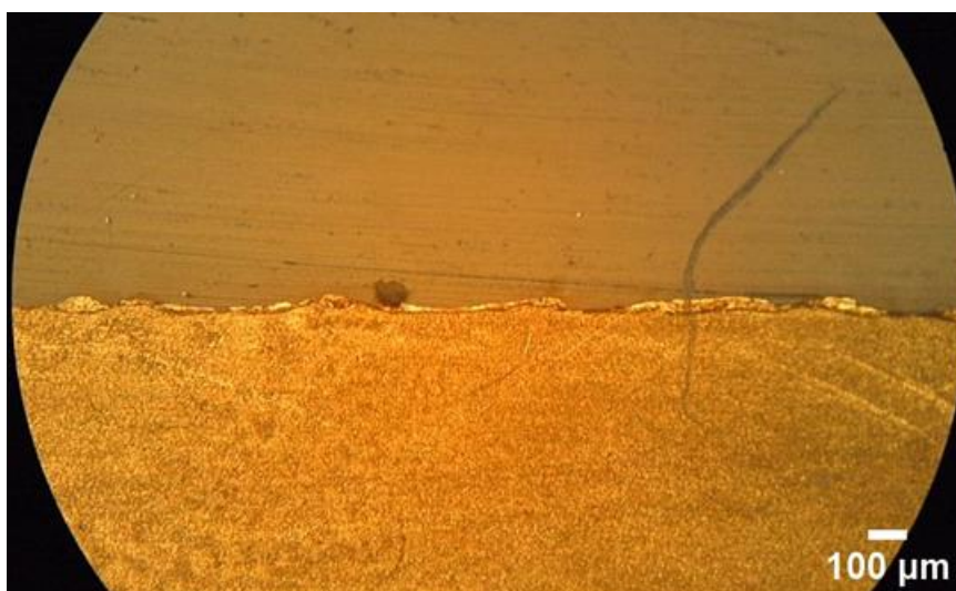
Εικόνα 39: Απεικόνιση του λεπτού στρώματος αναδιαμόρφωσης.
