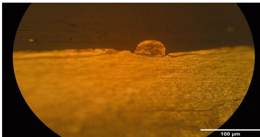
Εικόνα 43: Λήψη φυσαλίδας ως «θύλακα» στην κατεργασμένη επιφάνεια.
