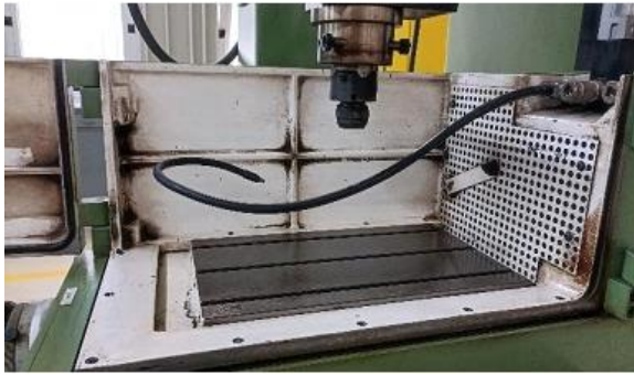
Εικόνα 8: Το εσωτερικό του δοχείου εργασίας της συσκευής EDM AGIETRON EMT 1.10.
