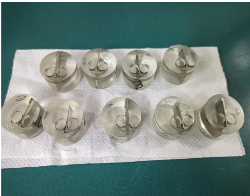
Εικόνα 25: Δοκίμια εγκιβωτισμένα στην ειδική ρητίνη.
