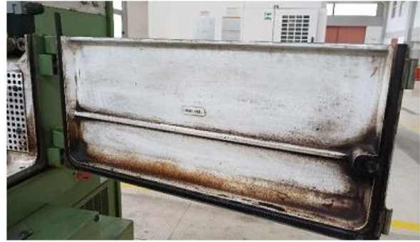
Εικόνα 8: Το εσωτερικό του δοχείου εργασίας της συσκευής EDM AGIETRON EMT 1.10.
