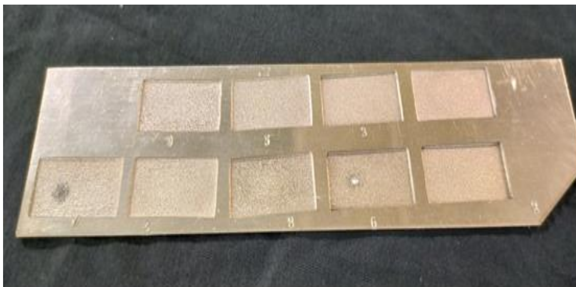
Εικόνα 20: Αποτυπώσεις ορθογώνιας γεωμετρίας σε πλάκα Νικελίου.
