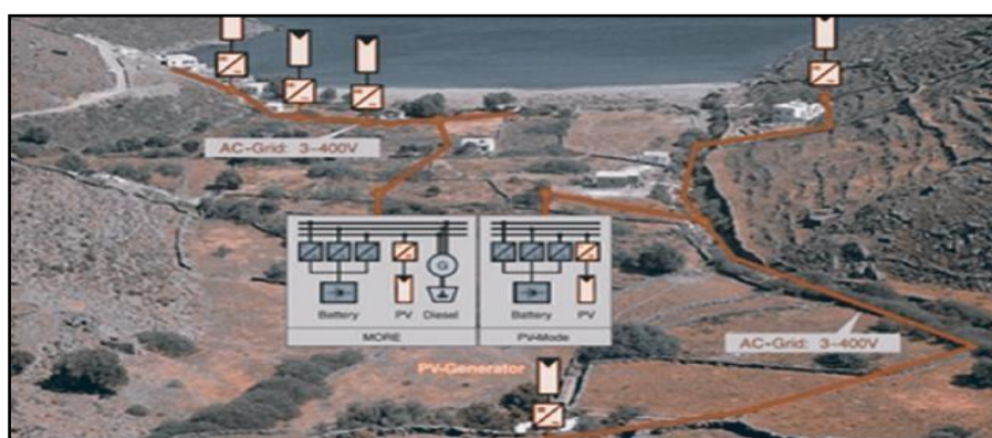
Εικόνα 2.30. Το μικροδίκτυο στον οικισμό της Γαϊδουρόμαντρας Πηγή: aegean-energy.gr
