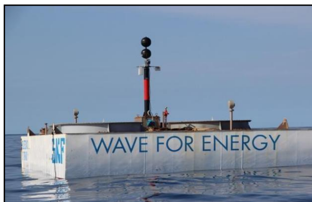
Εικόνα 2.20. Σύστημα παραγωγής ενέργειας από κύματα θάλασσας (ISWEC) στη Παντελλερία Πηγή: rienergia.staffettaonline.com
