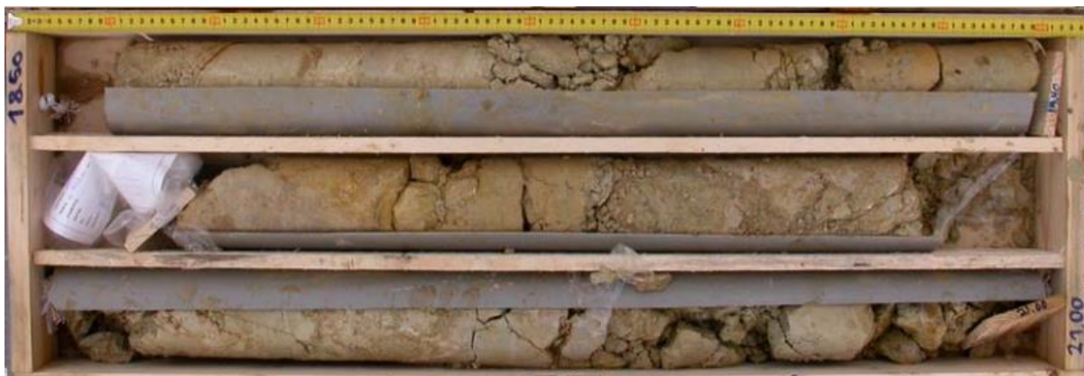
Εικόνα 3: Αντιπροσωπευτικοί πυρήνες της γεωτεχνικής ενότητας 2.1. Πετρογραφικός τύπος ασβεστίτου αργιολίθου, Γεώτρηση ΒΗ3308, βάθος 18,50m – 21,00m.
