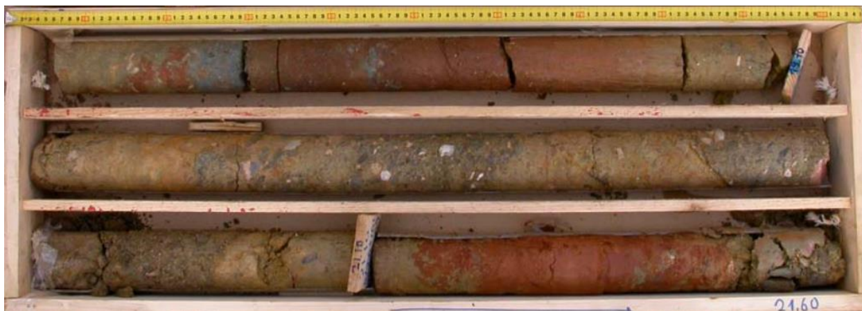
Εικόνα 11: Αντιπροσωπευτικοί πυρήνες της γεωτεχνικής ενότητας 2.5. Πετρογραφικός τύπος κροκαλολατυποπαγούς, Γεώτρηση BP3309, βάθος 18,70m – 21,60m.
