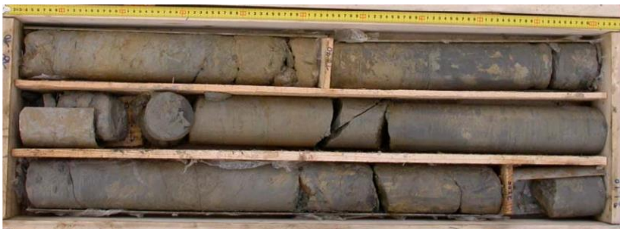
Εικόνα 4: Αντιπροσωπευτικοί πυρήνες της γεωτεχνικής ενότητας 2.1. Πετρογραφικός τύπος ιλυολίθου, Γεώτρηση ΒΡ3306, βάθος 18,10m – 21,10m.
