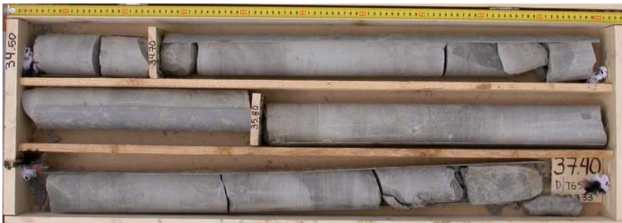
Εικόνα 6: Αντιπροσωπευτικοί πυρήνες της γεωτεχνικής ενότητας 2.2. Πετρογραφικός τύπος ασβεστίτου ιλιολίθου, Γεώτρηση ΒΡ3333, βάθος 34,50m – 37,40m.
