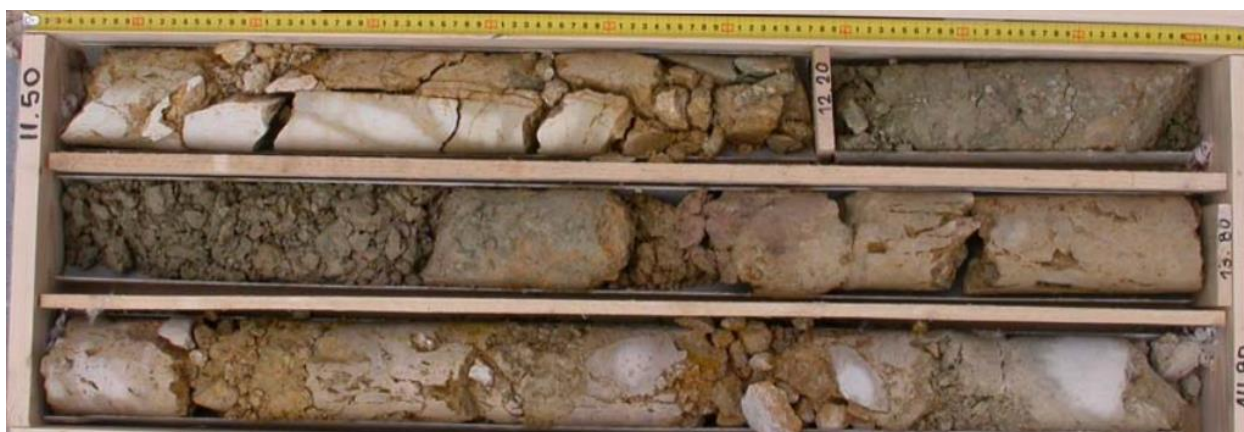
Εικόνα 10: Αντιπροσωπευτικοί πυρήνες της γεωτεχνικής ενότητας 2.4. Εναλλαγές μάρμας – μαργαϊκού ασβεστολίθου, Γεώτρηση BP3333, βάθος 11,50m – 14,80m.
