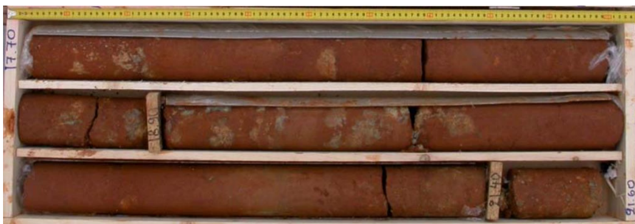
Εικόνα 12: Αντιπροσωπευτικοί πυρήνες της γεωτεχνικής ενότητας 2.5. Πετρογραφικός τύπος ερυθροπηλίτη, Γεώτρηση BP3310, βάθος 17,70m – 21,60m.
