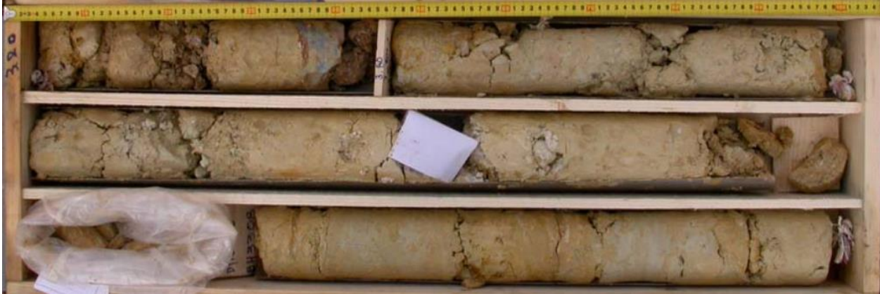
Εικόνα 5: Αντιπροσωπευτικοί πυρήνες της γεωτεχνικής ενότητας 2.1Α. Γεώτρηση ΒΗ3308, βάθος 3,20m – 6,50m.
