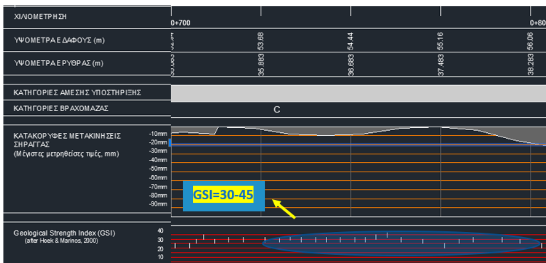
Εικόνα 44: Απόσπασμα από το σχέδιο «Δεδομένα συναντηθεισών γεωλογικών και τεχνικογεωλογικών συνθηκών “Ως κατασκευάσθη”», Χ.Θ. 0+720 έως Χ.Θ. 0+800.
