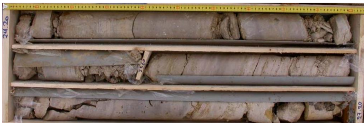
Εικόνα 8: Αντιπροσωπευτικοί πυρήνες της γεωτεχνικής ενότητας 2.3. Πετρογραφικός τύπος μαργαϊκού ασβεστολίθου, Γεώτρηση BP3306, βάθος 24,20m – 27,20m.
