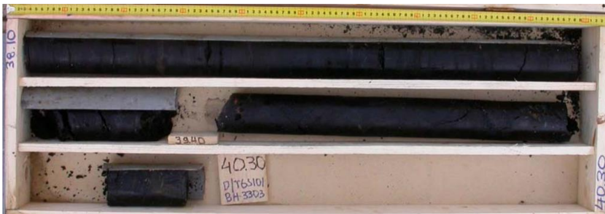
Εικόνα 7: Αντιπροσωπευτικοί πυρήνες της γεωτεχνικής ενότητας 2.2. Πετρογραφικός τύπος ασβεστίτου λιγνίτη, Γεώτρηση ΒΗ3303, βάθος 38,10m – 40,30m.
