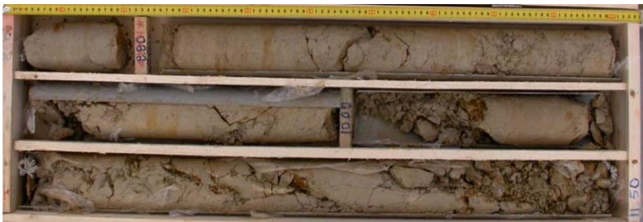
Εικόνα 2: Αντιπροσωπευτικοί πυρήνες της γεωτεχνικής ενότητας 2.1. Πετρογραφικός τύπος ασβεστιτικού αργιλολίθου, Γεώτρηση BP3305, βάθος 8,60m – 11,50m.
