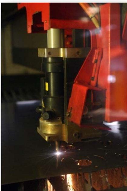
Σχήμα 5.9: Κοπή μαγνητικής λαμαρίνας με κοπτικό μηχανήμα CNC Laser CO 2
