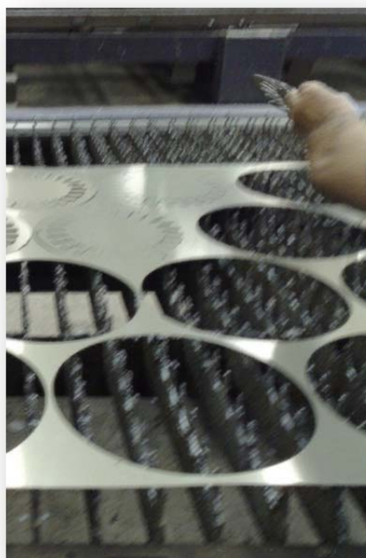
Σχήμα 5.9: Κοπή μαγνητικής λαμαρίνας με κοπτικό μηχανήμα CNC Laser CO 2
