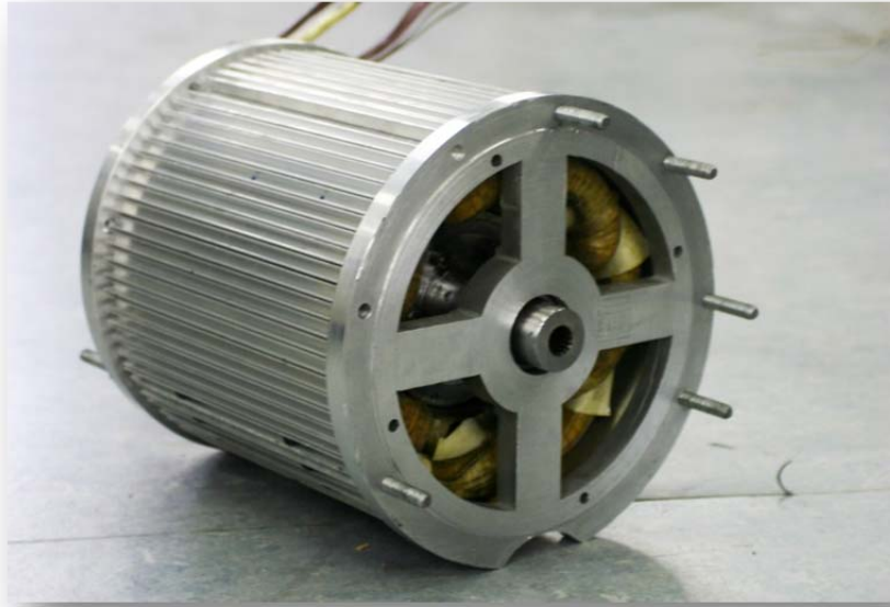
Σχήμα 5.20: Ολοκλήρωση της κατασκευής δοκιμίου κινητήρα επιφανειακών μαγνητών 63Kw
