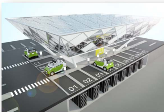
Σχήμα 1.2: Πρωτότυποι σταθμοί ανεφοδιασμού ηλεκτρικών οχημάτων με φωτοβολταϊκό σύστημα παραγωγής ενέργειας, εγκατεστημένο στην οροφή [1.24].
