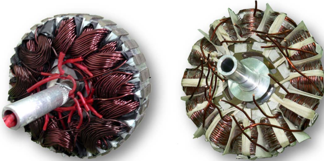
Σχήμα 5.5: Αριστερά: Στάτης δεκαπολικού κινητήρα πλήρους βήματος, συντελεστή πληρότητας 40% που χρησιμοποιήθηκε στον πρωτότυπο κινητήρα τροχό του οχήματος «Προμηθέας» 2009 του ΕΜΠ.
