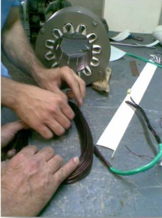
Σχήμα 5.3: Κατασκευή τυλίγματος πλήρους βήματος σε κινητήρα 63kW
