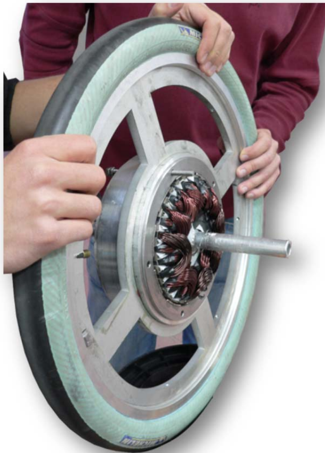
Σχήμα 5.21: 10πολικός κινητήρας κλασματικού βήματος πρωτότυπου οχήματος «Πυρφόρος» 2009
