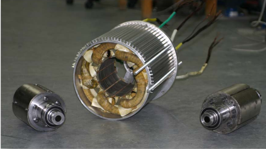
Σχήμα 5.17: Δοκίμο κινητήρα επιφανειακών μαγνητών ισχύος 63kW με εναλλάξιμους δρομείς, αποτελούμενους από τραπεζοειδείς και επιφανειακούς μαγνήτες
