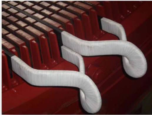
Σχήμα 5.3: Κατασκευή τυλίγματος πλήρους βήματος σε κινητήρα 63kW
