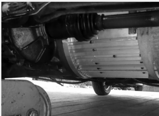
Σχήμα 6.17: Τοποθέτηση του κινητήρα ισχύος 63kW σε ένα πειραματικό SmartForTwo®
