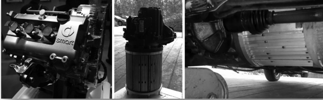
Σχήμα 7.5: Προσαρμογή ηλεκτροκινητήρα μονίμων μαγνητών στη θέση του θερμικού στο όχημα Smart
