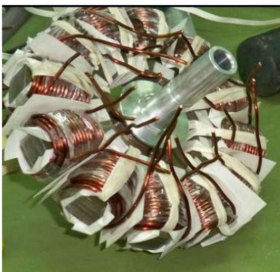
Σχ. 5α Φάση κατασκευής στάτη του κινητήρα μονίμων μαγνητών.
