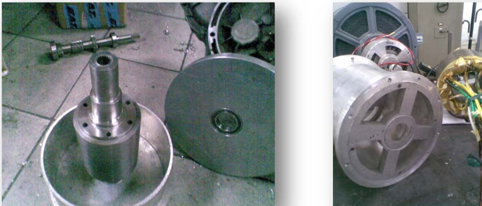
Σχήμα 5.16: Κατασκευή συμπαγούς δρομέα, καπακιών στήριξης και περιβλήματος
