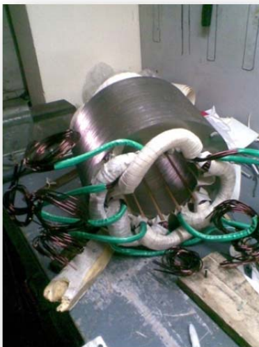
Σχήμα 5.1: Διάταξη ελαχιστοποίησης μήκους κεφαλών σε περιέλιξη πλήρους βήματος
