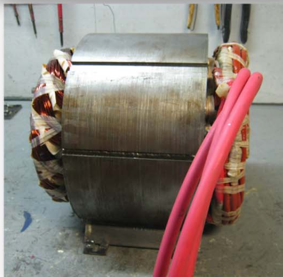
Σχήμα 5.2: Κατασκευή τυλίγματος πλήρους βήματος σε κινητήρα 63kW
