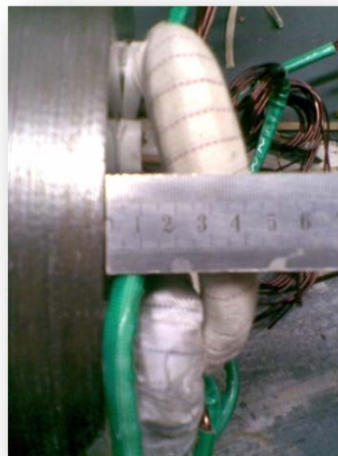
Σχήμα 5.1: Διάταξη ελαχιστοποίησης μήκους κεφαλών σε περιέλιξη πλήρους βήματος
