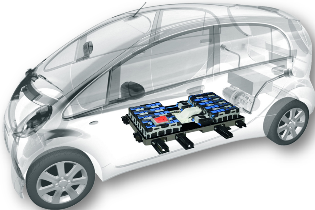
Σχήμα 1.12: Τοποθέτηση συστήματος μπαταρίας στο δάπεδο του ηλεκτρικού MiEV που αναπτύχθηκε σε συνεργασία της Peugeot και Mitsubishi [1.23].
