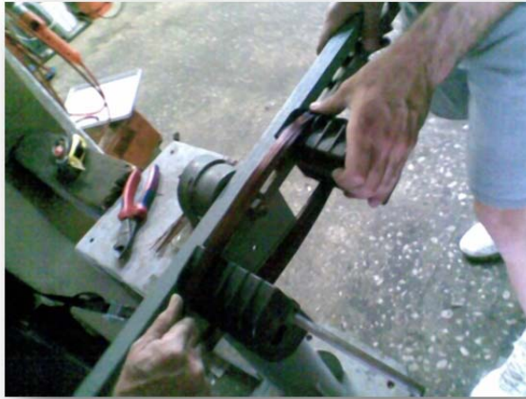
Σχήμα 5.3: Κατασκευή τυλίγματος πλήρους βήματος σε κινητήρα 63kW
