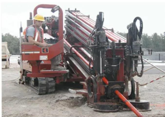
Εικόνα 2.5.3 Μηχάνημα οριζόντιας κατευθυνόμενης διάτρησης (Πηγή : https://www.directionaltech.com/directional-drilling/installation/ )
