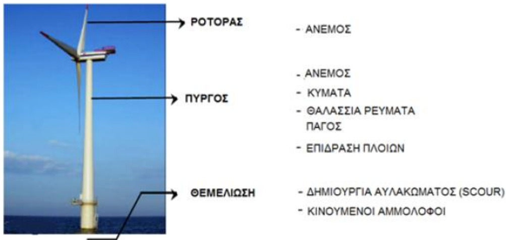
ΣΧΗΜΑ 17. Φορτία που καταπονούν την κατασκευή
