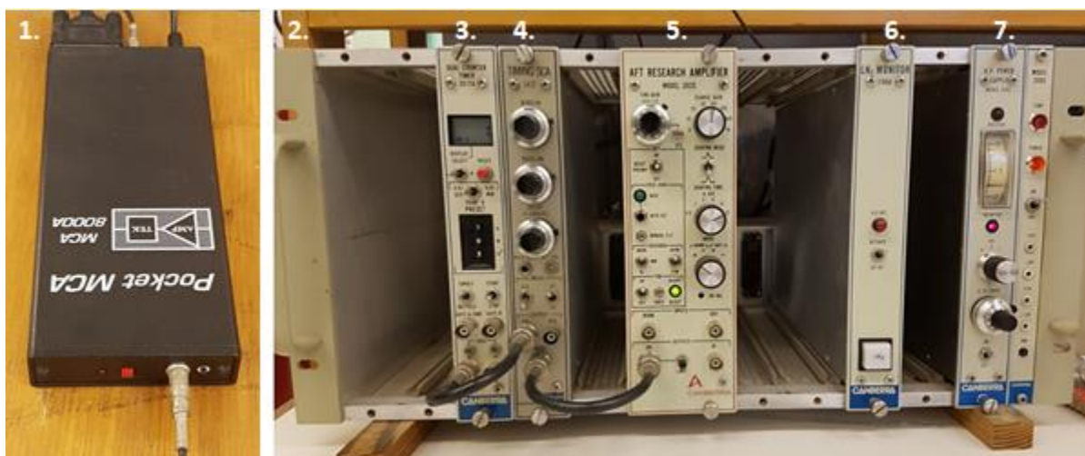
Εικόνα 4.3: Πυρηνικά ηλεκτρονικά: 1. Πολυκαναλικός αναλυτής, 2. Μονάδα NIM-BIN, 3. Διπλός Καταμετρητής/Χρονόμετρο, 4. Μονοκαναλικός αναλυτής χρονισμού, 5. Ενισχυτής, 6. Ελεγκτής στάθμης αζώτου και 7. Τροφοδοτικό Υ.Τ
