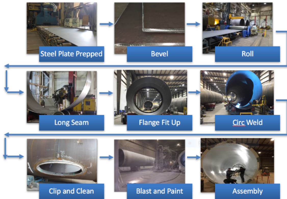
Σχήμα 8: Σειρά κατεργασιών για την κατασκευή του πύργου. [25]
