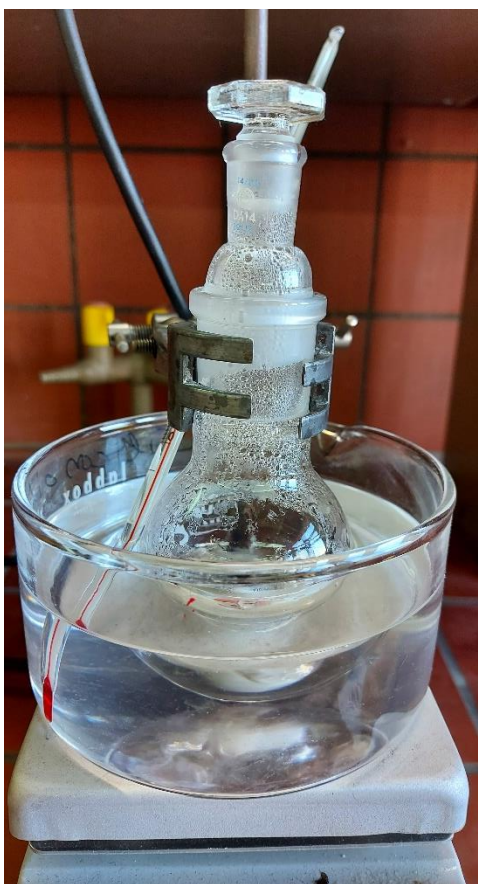
Εικόνα 8: Σύνθεση NADES. Δίνεται προσοχή στην διατήρηση της θερμοκρασίας στους 70 °C.
