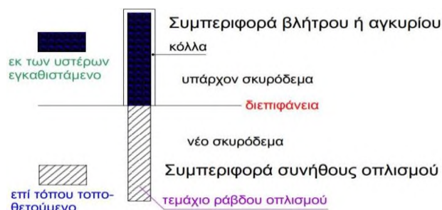
Εικόνα 5.3.2: Λειτουργία ράβδου οπλισμού κατά τη σύνδεση παλαιού μενούσκυροδέματος
