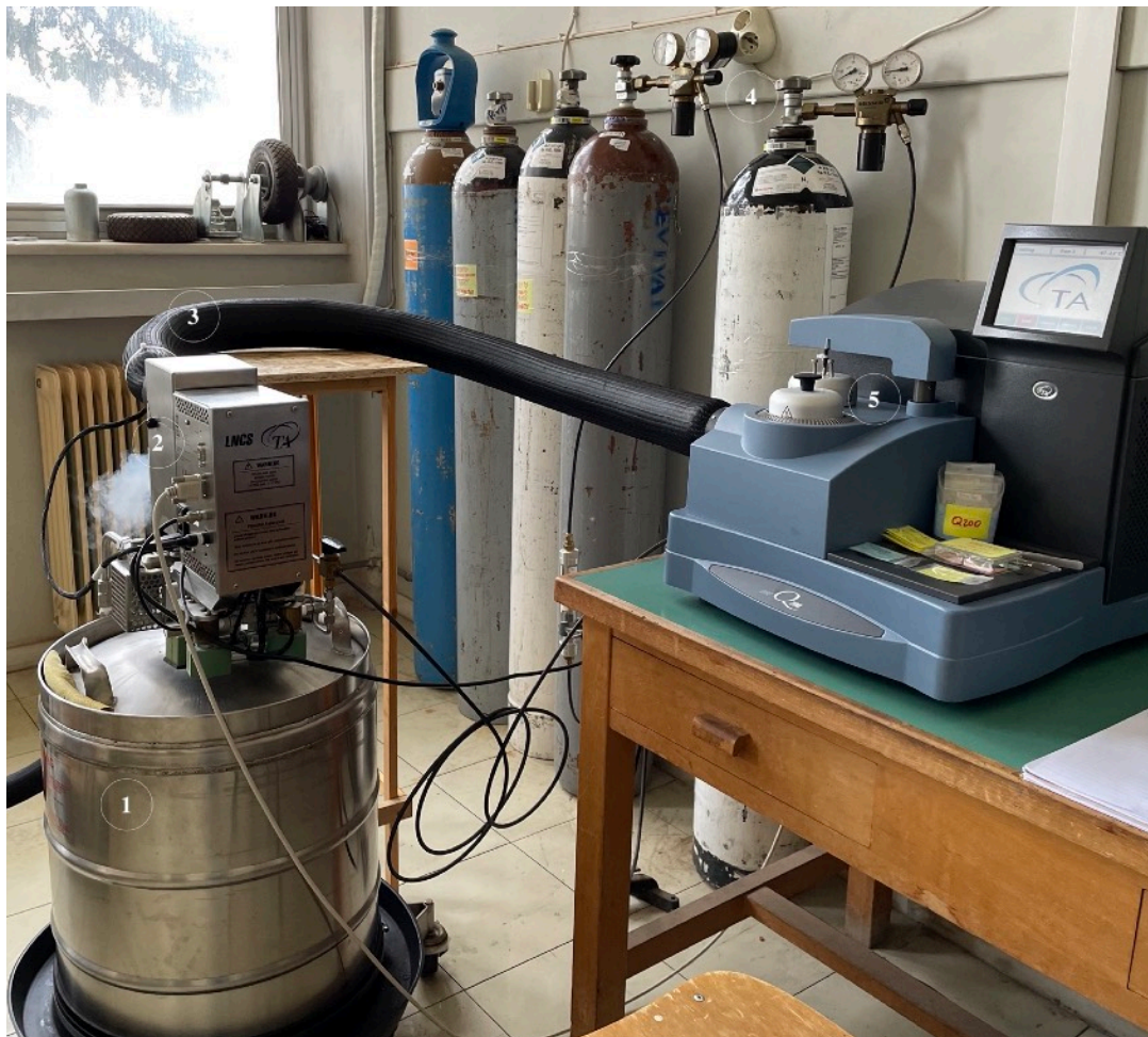
Φωτογραφία 3.13: Η μονάδα του DSC σε εργαστήριο του Εθνικού Μετσόβιου Πολυτεχνείου (Κτήριο Φυσικής, Πολυτεχνειούπολη Ζωγράφου, 2022).
