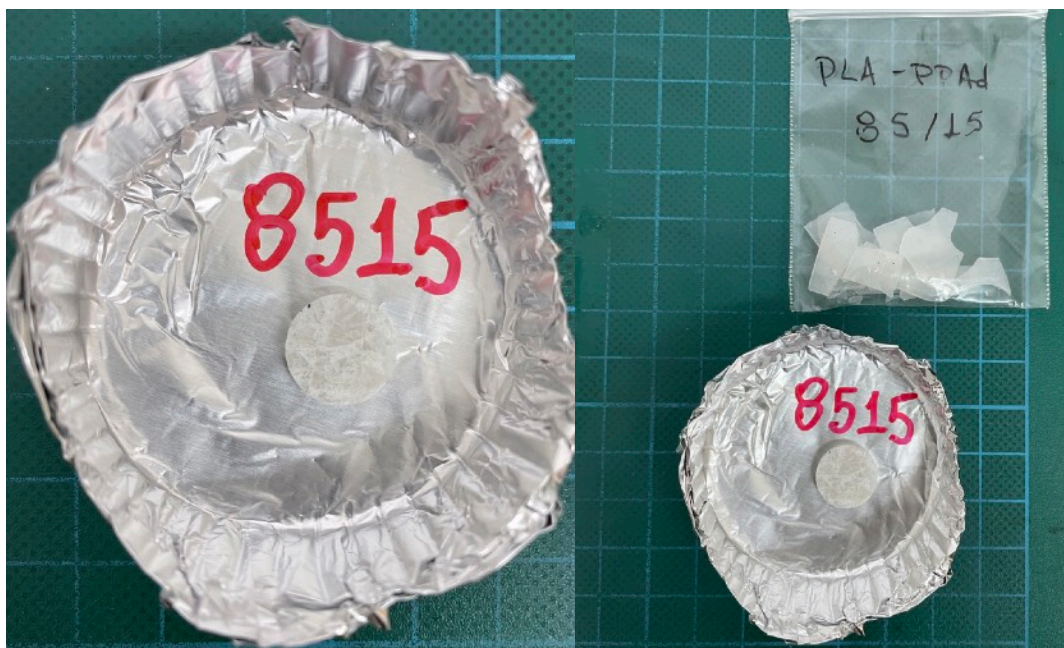
Φωτογραφία 3.3: Αριστερά, το δισκίο του 85/15 στη βάση του. Δεξιά, μαζί με θραύσματα του υλικού.
