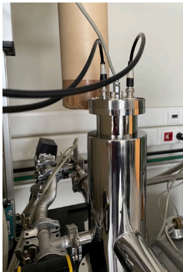
Φωτογραφία 3.17 & 3.18: Αριστερά, η κυψελίδα του DRS (DRS shell). Δεξιά, ο κρουοστάτης.
