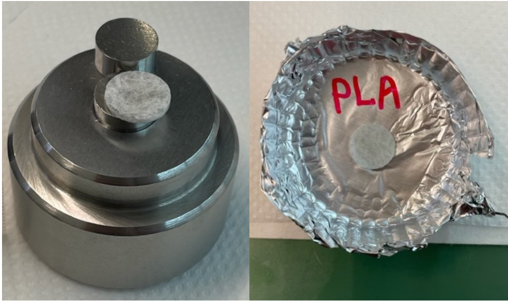
Φωτογραφία 3.1: Αριστερά, το δισκίο του PLA πάνω σε εξάρτημα της πρέσας, αμέσως μετά την κατασκευή του. Μπορούμε να διακρίνουμε πως πρόκειται για ένα σχετικά ημιδιαφανές υλικό. Δεξιά, το δισκίο του PLA στη βάση του.
