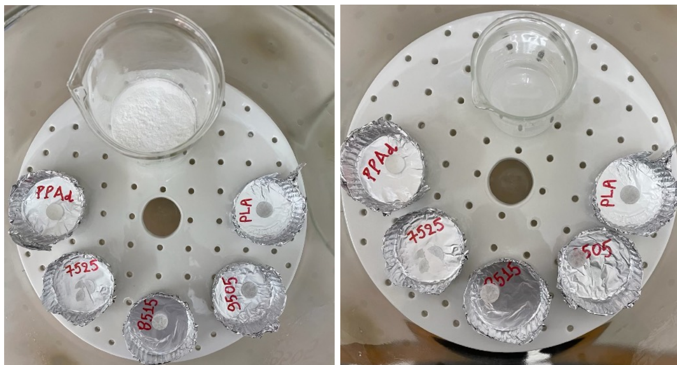
Φωτογραφία 3.6 & 3.7: Το εσωτερικό της γυάλας στην αρχή (αριστερά) και στο τέλος (δεξιά) της πρώτης εβδομάδας των πειραμάτων των υδατώσεων. Στην αριστερή εικόνα διακρίνεται το P 2 O 5 στο δοχείο ζέσεως σε μορφή άσπρης σκόνης, το οποίο και δημιουργεί το πιο ξηρό περιβάλλον που είναι δυνατόν να δημιουργηθεί (2% RH), δηλαδή συνθήκες υγρασίας όσο το δυνατόν κοντινότερες στο 0%. Στην δεξιά εικόνα διακρίνεται το P 2 O 5 μία εβδομάδα μετά. Είχε παραμείνει σκόνη στο μεγαλύτερο μέρος του, όμως στην πάνω επιφάνεια είχε σχηματιστεί μια λεπτή στρώση τζελ, γεγονός που αναμέναμε.
