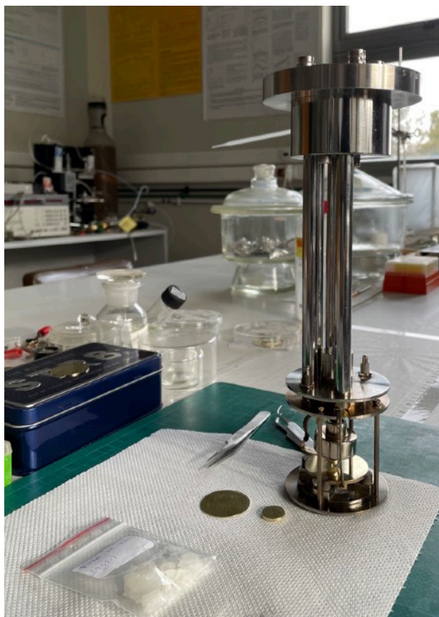
Φωτογραφία 3.17 & 3.18: Αριστερά, η κυψελίδα του DRS (DRS shell). Δεξιά, ο κρουοστάτης.
