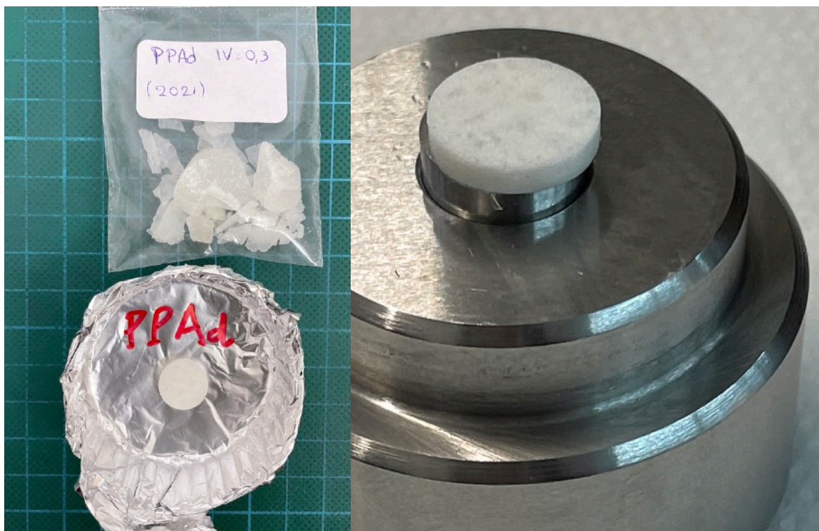
Φωτογραφία 3.5: Αριστερά, το δισκίο του PPAAd στη βάση του και θραύσματα του υλικού. Δεξιά, το δισκίο πάνω σε εξάρτημα της πρέσας.
