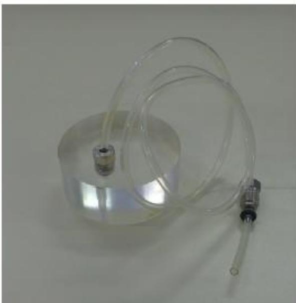
Είναι το καπάκι του δοκιμίου που τοποθετείται στην κορυφή του μετά την πλήρωση της μεμβράνης με το προς εξέταση εδαφικό υλικό. Έχει κυλινδρικό σχήμα με τη διάμετρο του δοκιμίου αλλά πολύ μικρότερο ύψος από το δοκίμιο. Είναι κατασκευασμένο από plexy glass και διαθέτει ένα σωληνάκι με το οποίο επιτρέπει στο δοκίμιο να επικοινωνεί με το volume change box και το αντίστοιχο interface και να ανταλλάσει την αναγκαία ποσότητα νερού.
