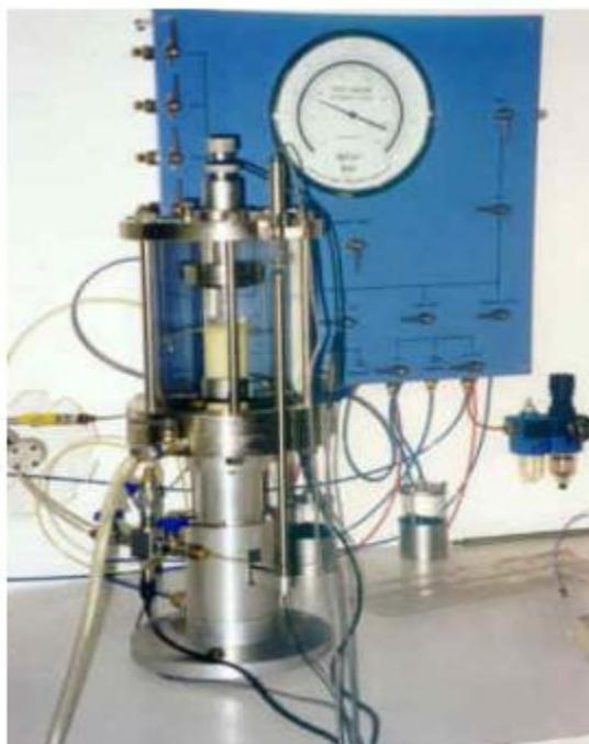
Σχ. 7.1 : Συσκευή Τριαξονικής Δοκιμής ελεγχόμενων διαδρομών τάσεων ΕΜΠ
