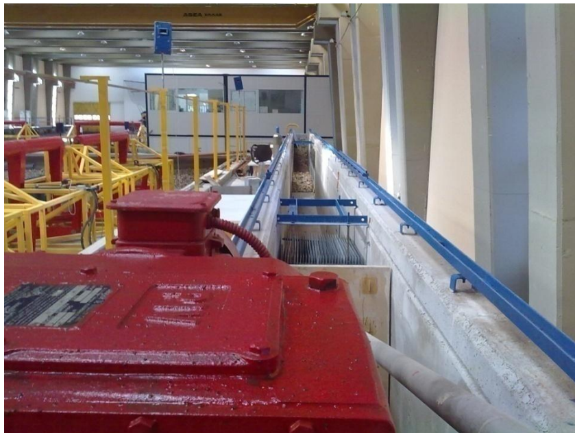
Σχήμα 3.1.1.2 – Άποψη της πειραματικής διώρυγας από την πλευρά της κυματογεννήτριας.
