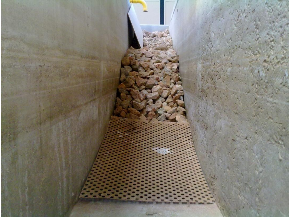
Σχήμα Β.3 – Στοιβάδα απορρόφησης κυματικής ενέργειας (sponge)
