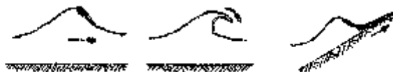
Σχήμα 2.2.2 – Διάφορα είδη θραύσεως κυμάτων (στο μέτωπο, στην κορυφή και στη βάση αντίστοιχα).
