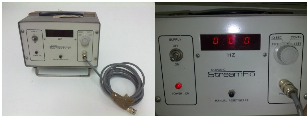
Σχήμα 3.2.1-3.2.2 – Novonic StreamFlo – Η επιστημονική συσκευή που χρησιμοποιήθηκε για τις πειραματικές μετρήσεις.
