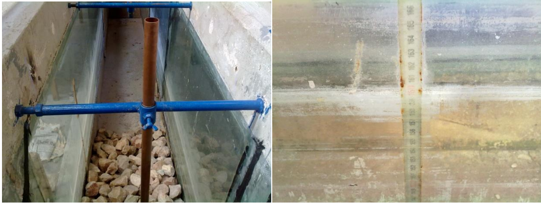
Σχήμα 3.2.5-3.2.6 – Οριζόντιοι υποδοχείς των ανοξείδωτων σωλήνων και βαθμονομημένος γνώμονας για τις οπτικές παρατηρήσεις.
