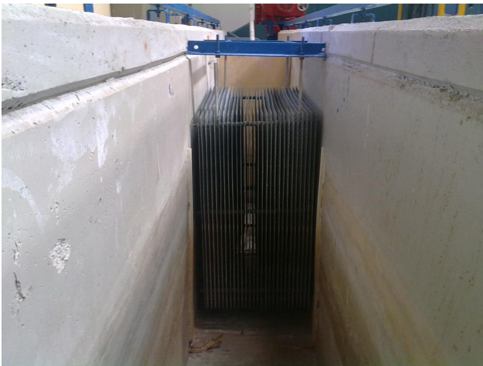
Σχήμα Β.2 – Διάτρητες μεταλλικές πλάκες για τον περιορισμό της περίθλασης
