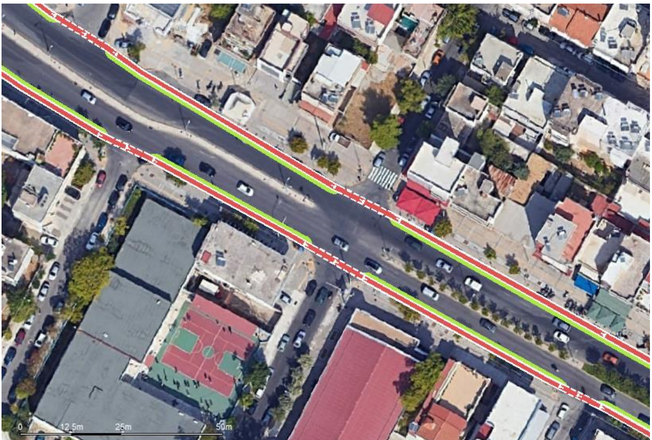
Εικόνα 82: Κάτοψη ποδηλατικής υποδομής 2ου τμήματος Ιεράς Οδού
