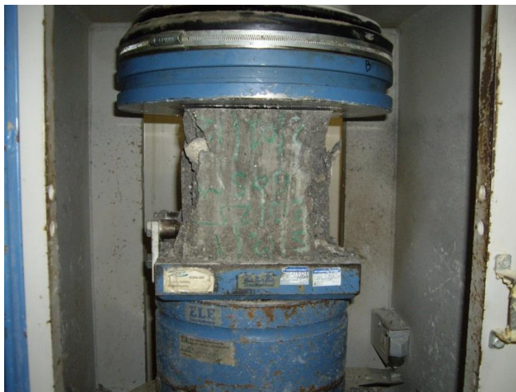
Εικόνα 11. Δοκίμιο με αποδεκτή μορφή θραύσης.
