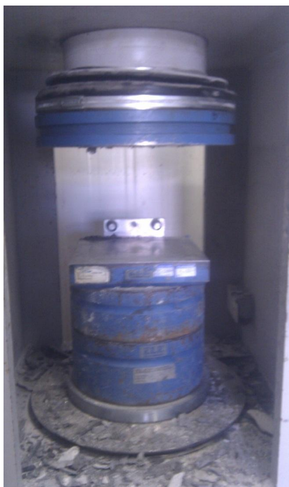
Εικόνα 9. Η μηχανή της δοκιμής σε θλίψη.
