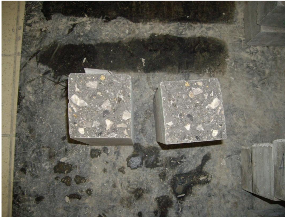
Εικόνα 7. Τα δύο τμήματα αμέσως μετά την θραύση.
