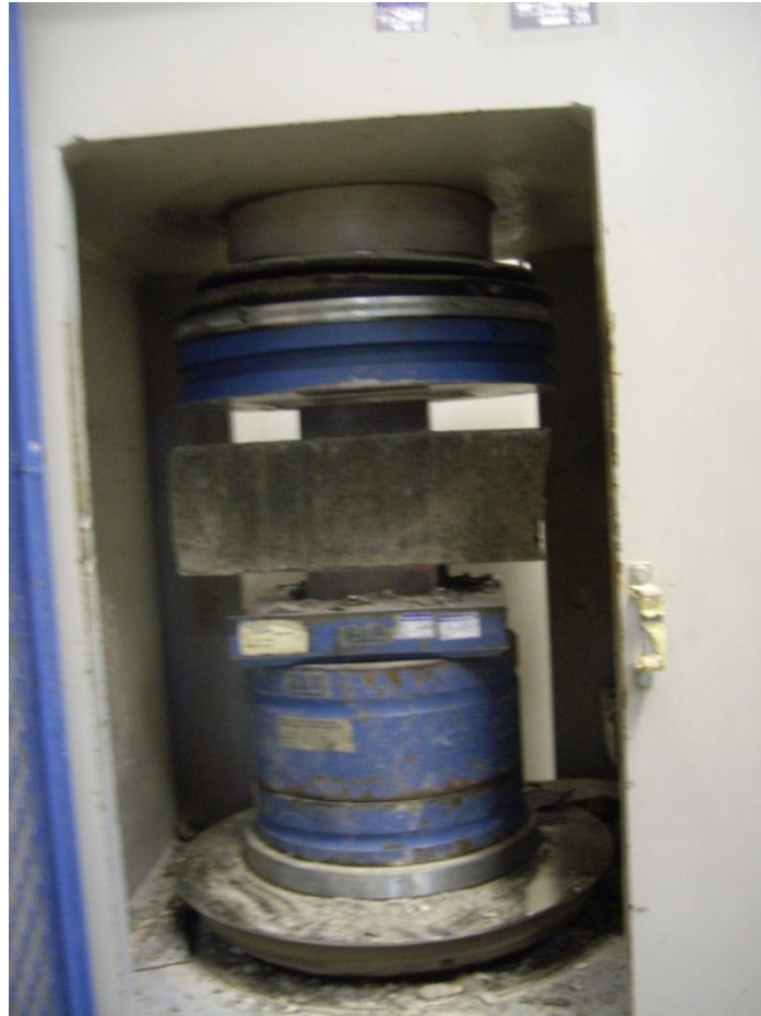
Εικόνα 13. Τμήμα τοποθετημένο στην μηχανή με τις δύο μεταλλικές πλάκες διαστάσεων 10x10 cm για την δοκιμή σε θλίψη ισοδύναμου κύβου.
