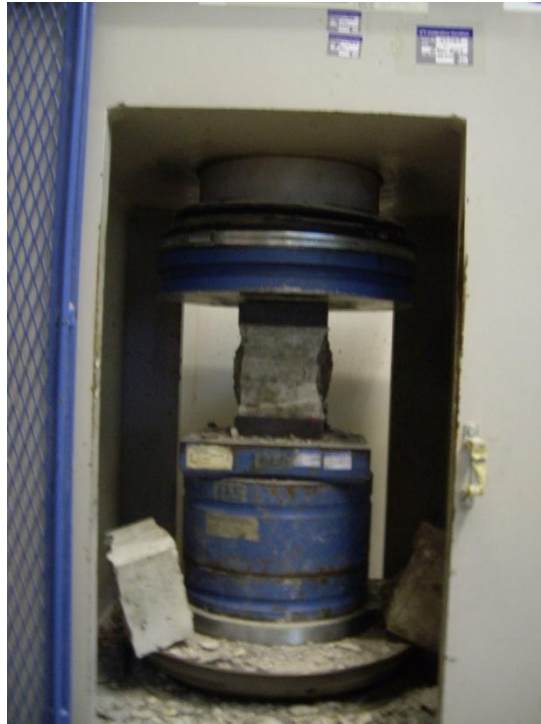
Εικόνα 14. Το τμήμα μετά την θραύση.
