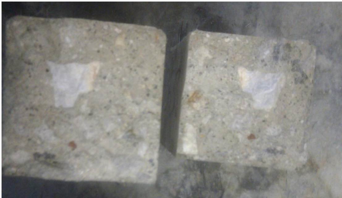
Εικόνα 8. Χαρακτηριστική περίπτωση πολύ μεγάλου αδρανούς.
