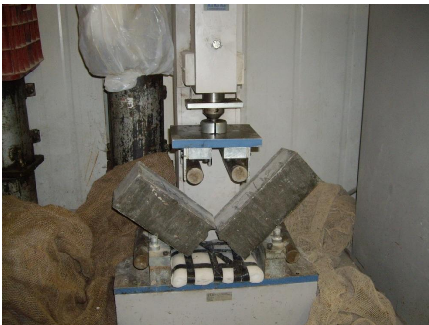
Εικόνα 5. Δοκίμιο αμέσως μετά την θραύση
