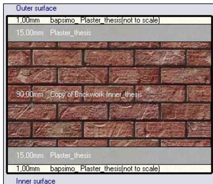
Εικόνα 103 Υπολογισμός Συντελεστή θερμοπερατότητας U_t εσωτερικής τοιχοποιίας
